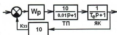
25. Провести налагоджування зовнішнього контуру регулювання швидкості в електроприводі на технічний оптимум. (КС(ТО) – контур струму з регулятором ТО).
