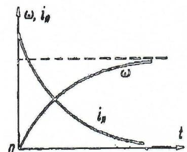
24. Провести налагодження внутрішнього контуру регулювання струму в електроприводі на технічний оптимум. (ТП – тиристорний перетворювач. ЯК – якірне коло.
