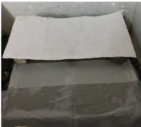
Рисунок 1 – Лабораторна камера (процес заповнення камери бетонними зразками і фільтрувальним папером)
