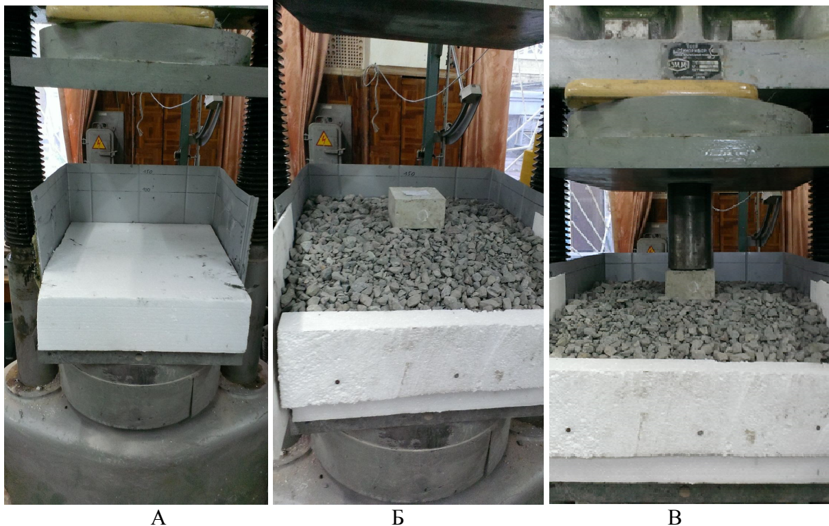
Рисунок 1 – випробування з квадратним штампом №1: А – рамка та полістирол для відбитку; Б – щебенева розподільча подушка та квадратний штамп з ребром 100 мм; В – передача навантажень пресом на штамп та розподільчу подушку.
