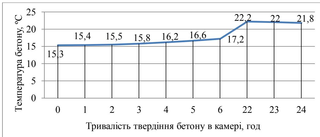
Рисунок 2 – Температура бетону в період твердіння в камері
