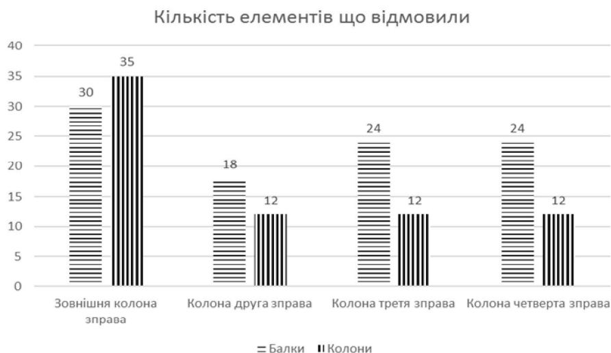
Рис.4. Діаграма кількості елементів, в яких напруження перевищують розрахункові при відмові відповідних колон першого поверху
