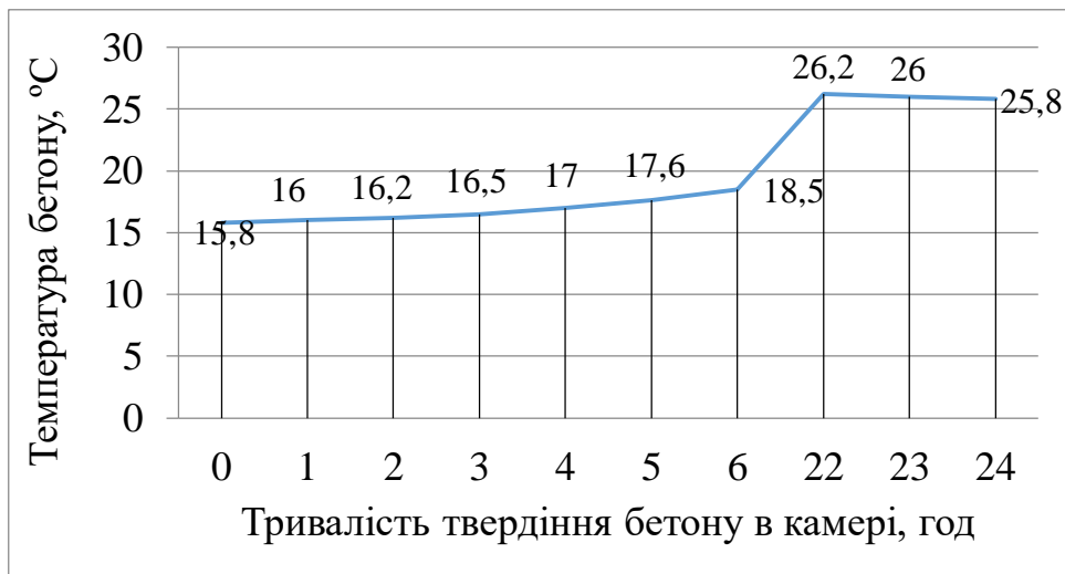
Рис. 2. Зміна температури бетону в період твердіння в камері
