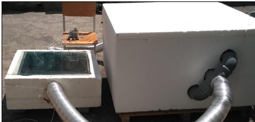
Рис. 1. Установка для теплової обробки бетонних тротуарних плит
