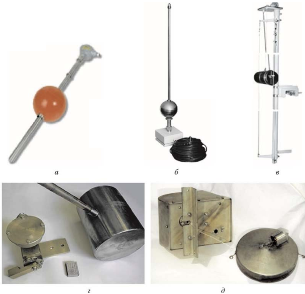
Рис. 1. Датчики рівня поплавкові: а – герконовий: PitLevelSensor (PLS) (Weatherford); б – магнітострикційний: Дубров (СКБ «Ореол»); в – потенциометрический ДУП-1 (ЗАТ АМТ); г – штанговий: ДУ-Ш (ВАТ НІФ «Геофізика»); д – безштангової: УПБ-М (ТІГ)
