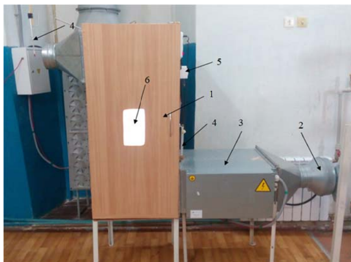
Рис. 1. Загальний вид стенду: 1 – сушильна камера, 2 - повітряний нагнітач, 3 - електричний калорифер, 4 – спиртовий термометр, 5 – частотний регулятор обертів, 6 – оглядове віконце.
