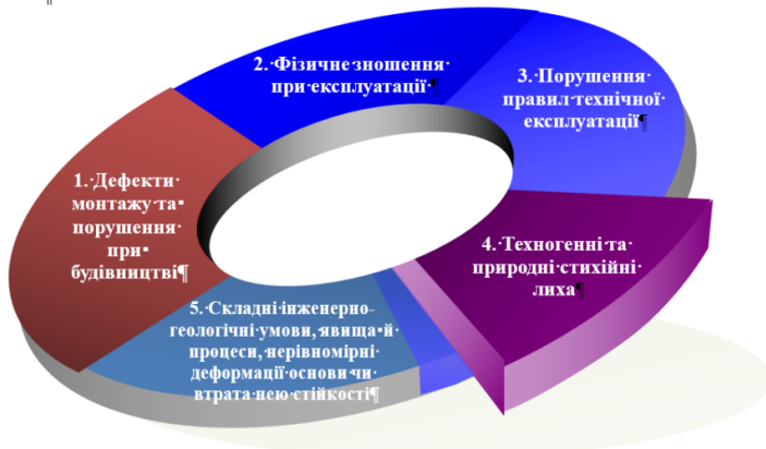
Рис. 1. Основні причини аварій резервуарів
