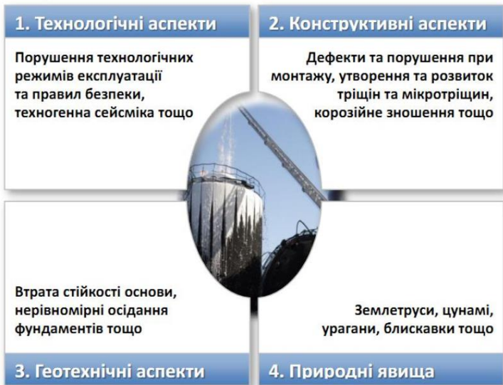
Рис. 2 Домінуючі аспекти основних причин аварій резервуарів
