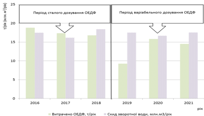
Рисунок 4 – Середньорічні кількості ОЕДФ, витрачені для стабілізаційної обробки води ОСО ВП РАЕС (Джерело: власні дослідження)
