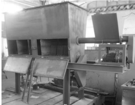
Рисунок 3 – Загальне фото розробленої в ІТТФ НАН України роторної сушильної установки з можливістю сушки тріски паливної (Джерело: складено автором на основі [3])
