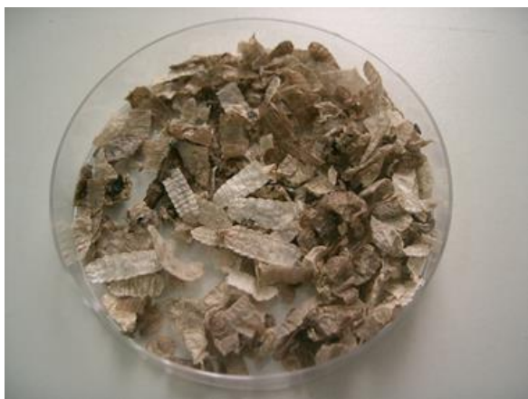
Рис. 1. Сорбенти на основі оболонок личинок Hermetia illucens (Литва, спільний проект FlyChitin, програма Eureka)
