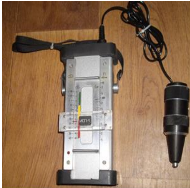
Рис.2. Віброметр ИСП-1 для вимірювання значень ударних імпульсів (dB) у контрольних точках дослідної моделі вібростолу.
