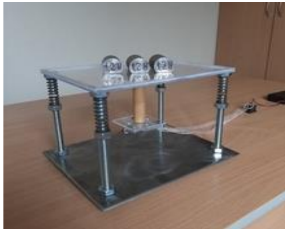
Рис. 1. Дослідна модель вібростолу з важільним закріпленням вібробудувача.
