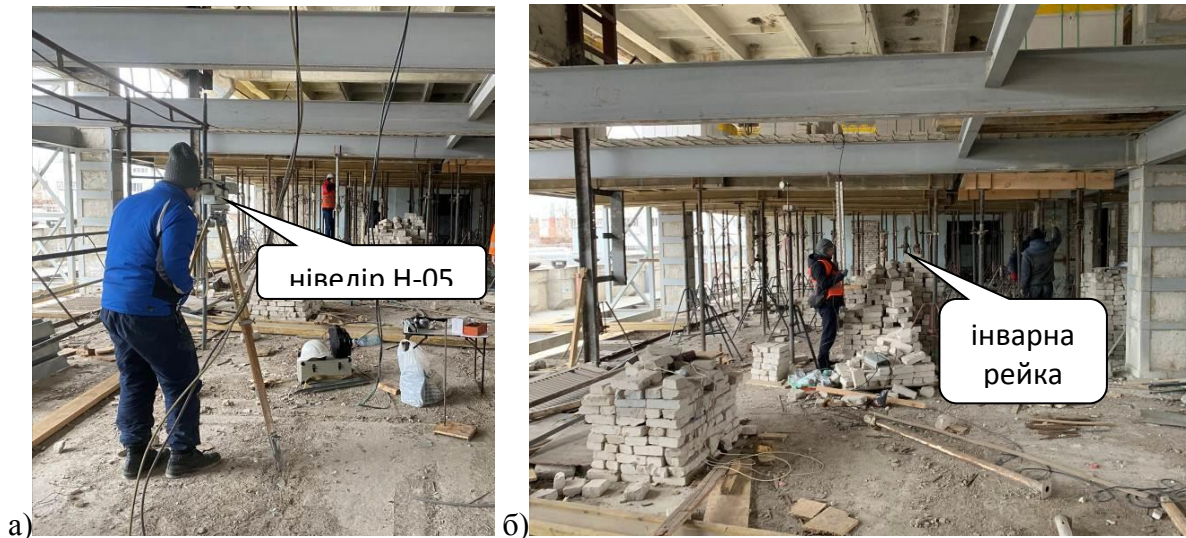
Рис. 2. Проведення нівелювання вертикальних зміщень контрольних точок балок
