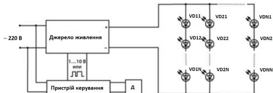
Рис. 1 – Схема світлодіодного світильника з функцією димінгу
