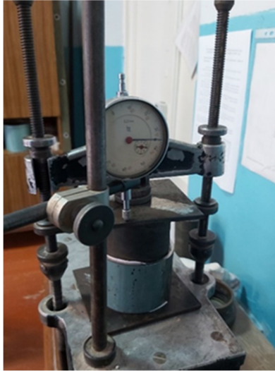
Рисунок 2 – Вимірювання навантаження на віброопору з обмежувачем
