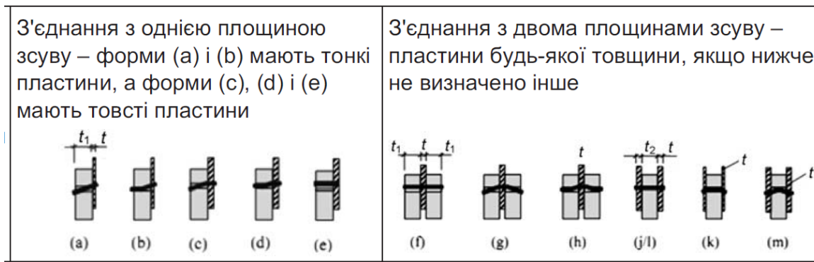
Рис. 2. Форми руйнування кріпильного елемента по площині зсуву
