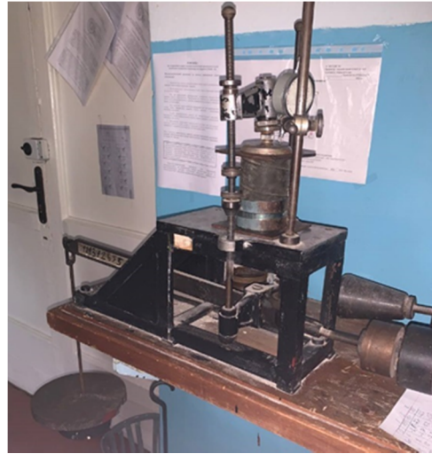
Рисунок 2 – Вимірювання навантаження на віброопору з обмежувачем
