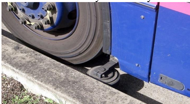
Рисунок 4 – Направляючий ролик автобуса
