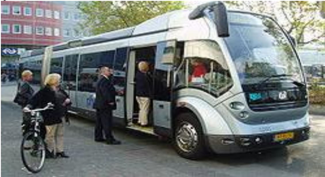
Рисунок 9 - Напрямний автобус, що керується двома відеокамерами
