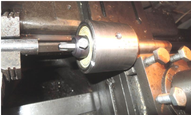
Рисунок 1 – Спосіб виготовлення профільних отворів шляхом ротаційного накочування: а – вигляд ротаційної голівки; б – спосіб закріплення у різцетримачі
