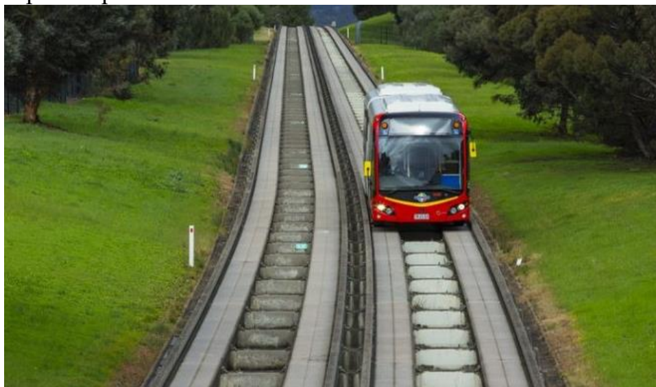
Рисунок 5 – Напрямний автобус на дорозі з бетонними рейками
