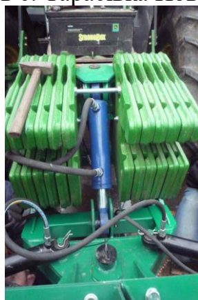
Рисунок 5 – Встановлення гідроциліндрів підйому-опускання та повороту відвалу в проміжку між секціями противаг.
