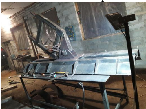
Рисунок 3 – Процес виготовлення пропонованого снігоприбирального робочого обладнання власноруч.
