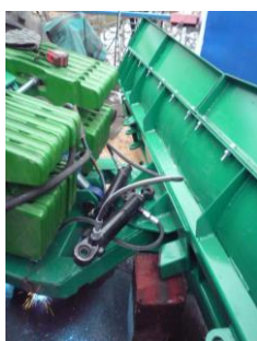
Рисунок 5 – Встановлення гідроциліндрів підйому-опускання та повороту відвалу в проміжку між секціями противаг.
