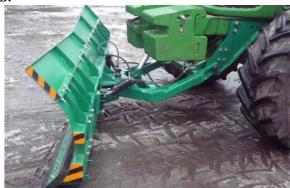
Рисунок 7 – Загальний вигляд колісного трактора John Deere 6930 з пропонованим універсальним бульдозерним робочим обладнанням під час натурних випробувань.
