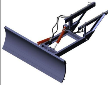
Рисунок 1 – Типові конструкції відвалів, що мають можливість встановлення під кутом до напрямку руху базової машини.
