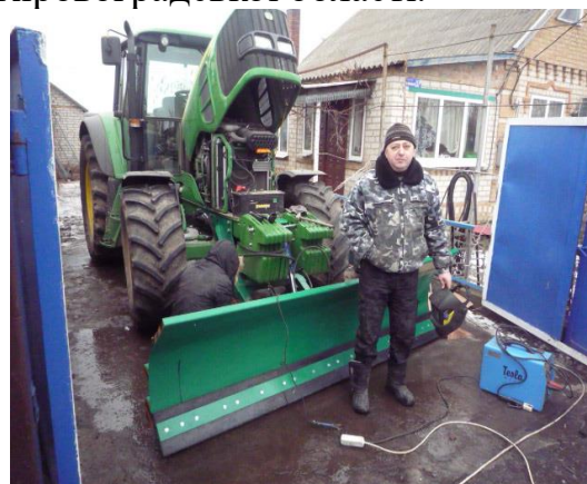
Рисунок 6 – Процес монтажу снігоприбирального відвалу власної конструкції.
