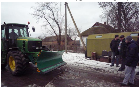
Рисунок 7 – Загальний вигляд колісного трактора John Deere 6930 з пропонованим універсальним бульдозерним робочим обладнанням під час натурних випробувань.
