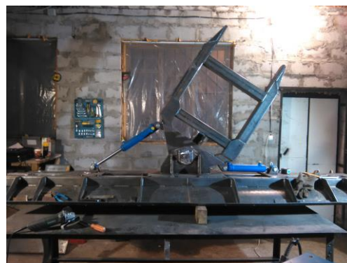
Рисунок 3 – Процес виготовлення пропонованого снігоприбирального робочого обладнання власноруч.
