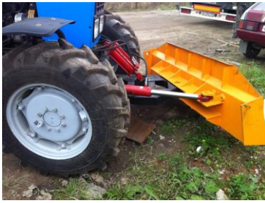
Рисунок 1 – Типові конструкції відвалів, що мають можливість встановлення під кутом до напрямку руху базової машини.
