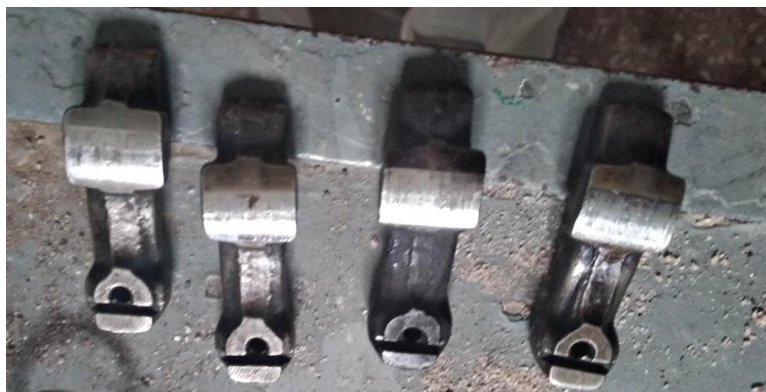
Рисунок 1 – Зношування поверхонь тертя деталей механізму газорозподілу двигуна внутрішнього згоряння
