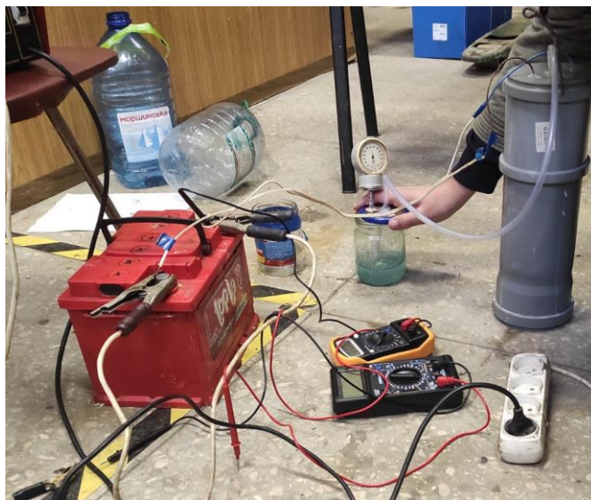
Рисунок 1 – Експериментальна установка для отримання водню шляхом електролізу
