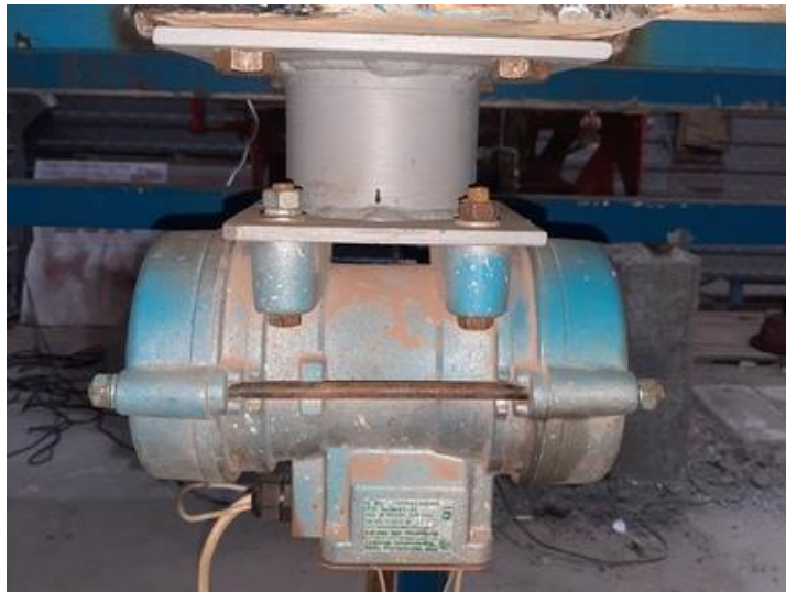
Рисунок 2 – Вібробуджувач 0,5 кВт з важілем 0,1 м.
