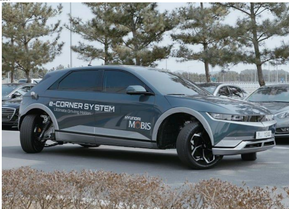
Рисунок 1 – Застосування технології e-Corner
