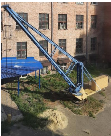
Рисунок 2 – Лабораторний кран на колоні
