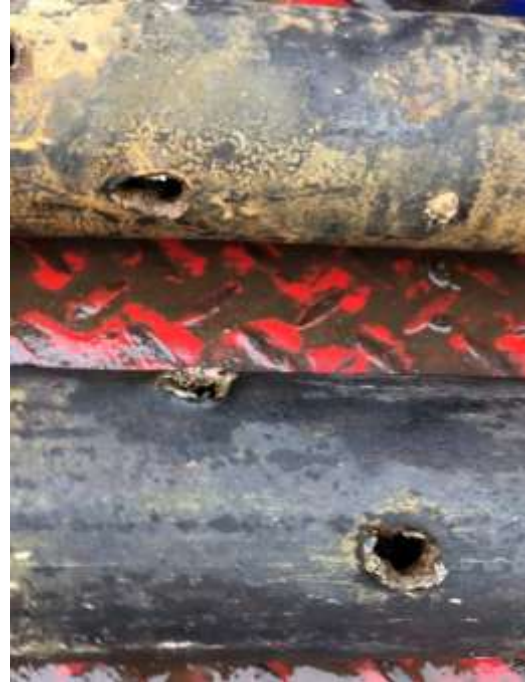
Рис. 2 – Стан обсадної колони після застосування компоновки Stimtube
