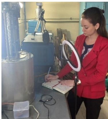
Рисунок 6 – Зняття показів температури по термометру Бекмана для калібрування калориметру
