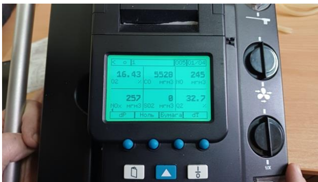
Рисунок 6 – Показники газоаналізатора TESTO 350-S при спалюванні гофрокартону
