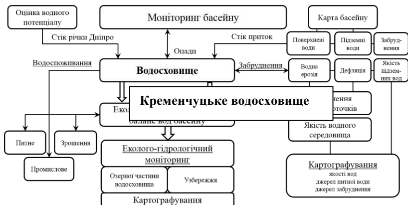
Рисунок 1 – Структурно-логічна схема гідроecологічного моніторингу водного середовища Кременчуцького водосховища
