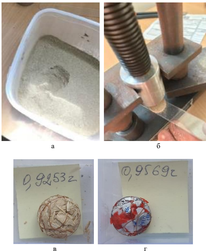
Рисунок 3 – Підготовка досліджуваних зразків для вимірювань калорійності
