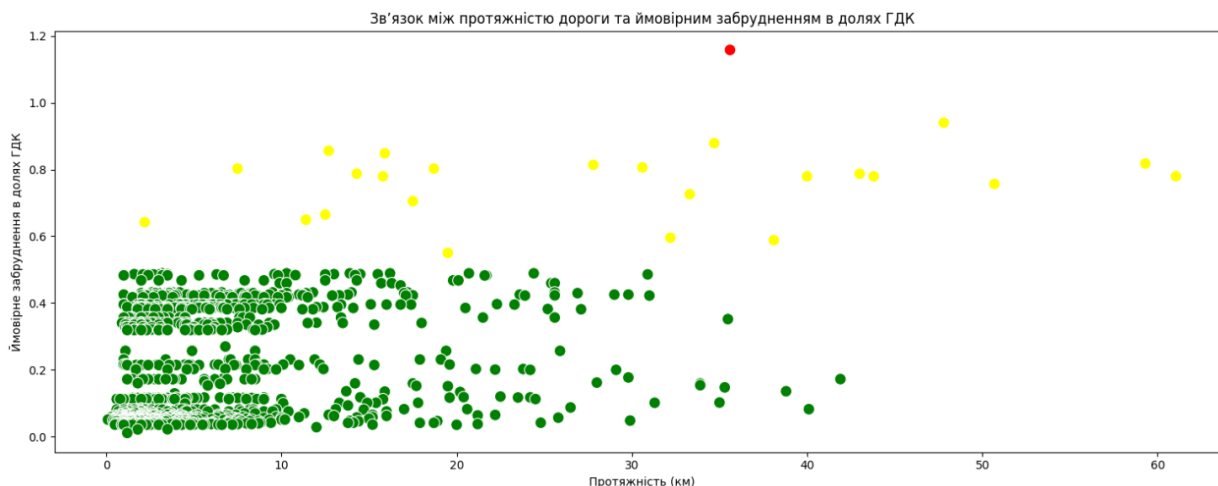
Рисунок 2. Зв'язок між протяжністю дороги та ймовірним забрудненням у частках ГДК залежно від інтенсивності руху
