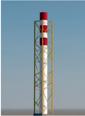
а. Підтримка труби нерегулярною конструкцією
