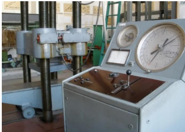
Рисунок 3 – Випробувальний прес ПГ-500
