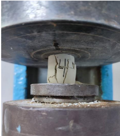
Рис.1 - Руйнування зразків при додаванні 10% магnezіального в'язучого
