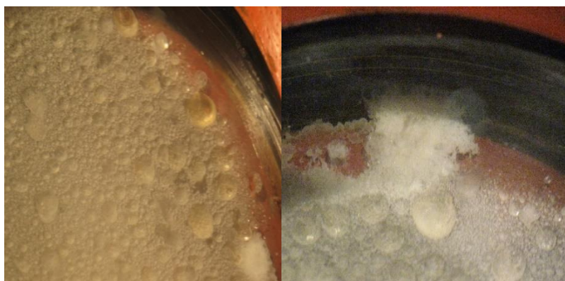
Рис. 2 Зовнішній вигляд газогідрату утвореного із водометанольного розчину (віскерні)
