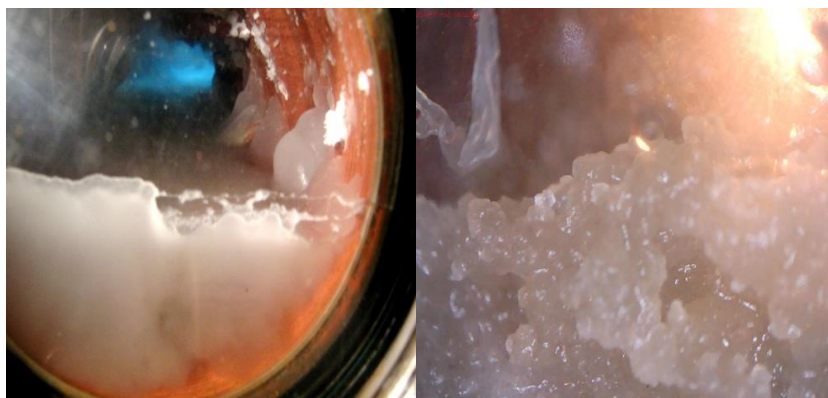
Рис. 1 Зовнішній вигляд газогідрату утвореного із водоетанольного розчину (гелеподібні)
