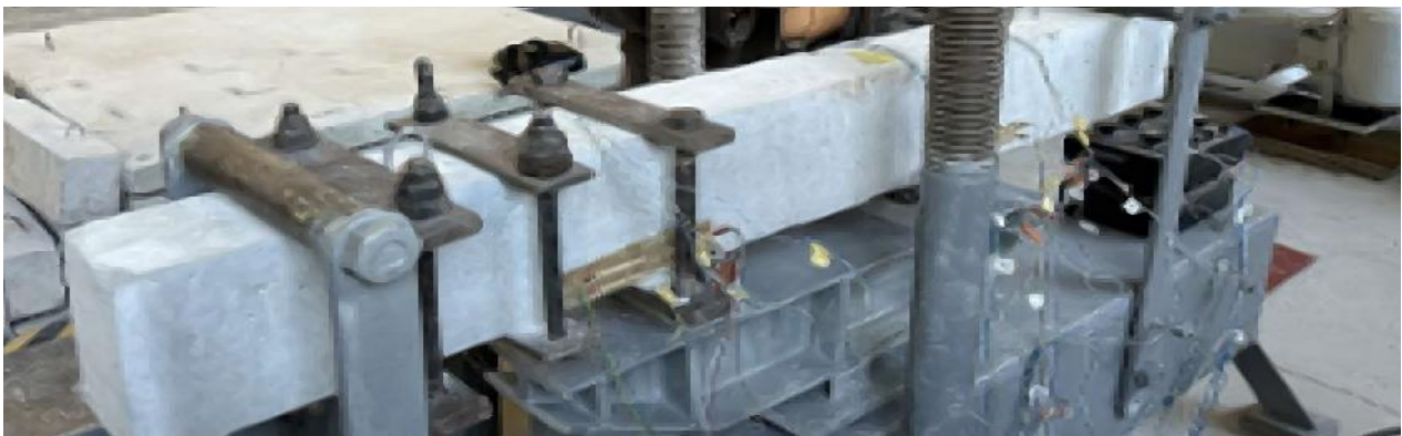
Рисунок 1 – Дослідна балка в силовій установці перед випробуванням
