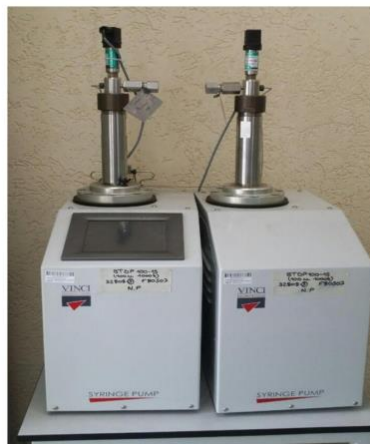
Рис. 2 Насос високого тиску для фільтраційних досліджень
