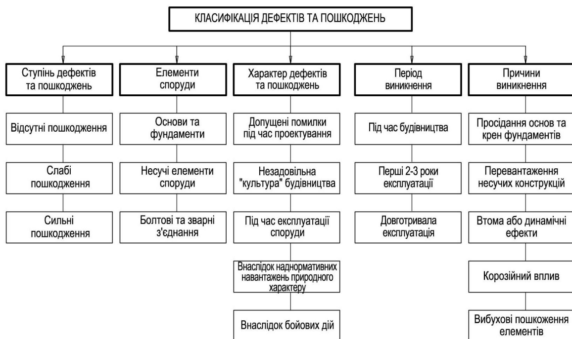
Рис. 1. Класифікація дефектів та пошкоджень антенних споруд зв'язку
