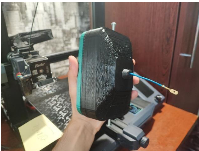
Рисунок 1 – Корпус фари на вантажний автомобіль КАМАЗ 4310 виготовлений за допомогою технології 3D друку
