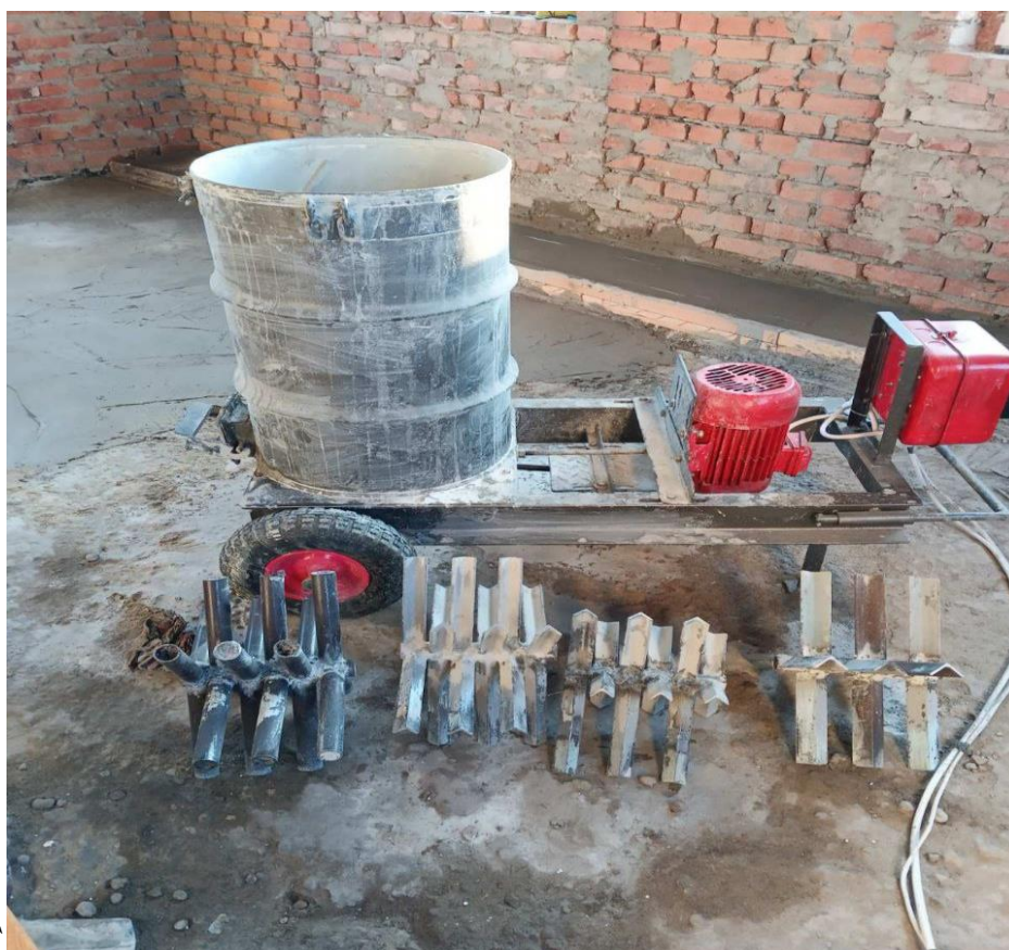
Рисунок 1 – Змішувач для приготування ніздрюватих бетонів та його робочі органи
