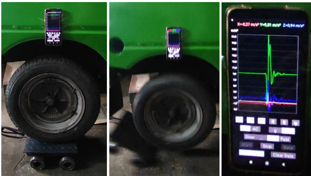
Рисунок 3 – Зняття робочих процесів підвіски автомобіля методом вільного падіння
