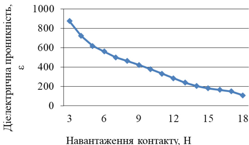
Рисунок 3 – Графік залежності діелектричної проникності адсорбованого шару ПАР від навантаження сполучення «кулька-площина»
