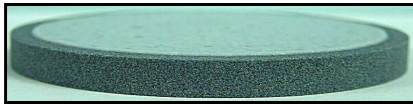
Рисунок 2. Вигляд сформованої фільтраційної кірки при тестуванні RDF на приладі НРНТ
