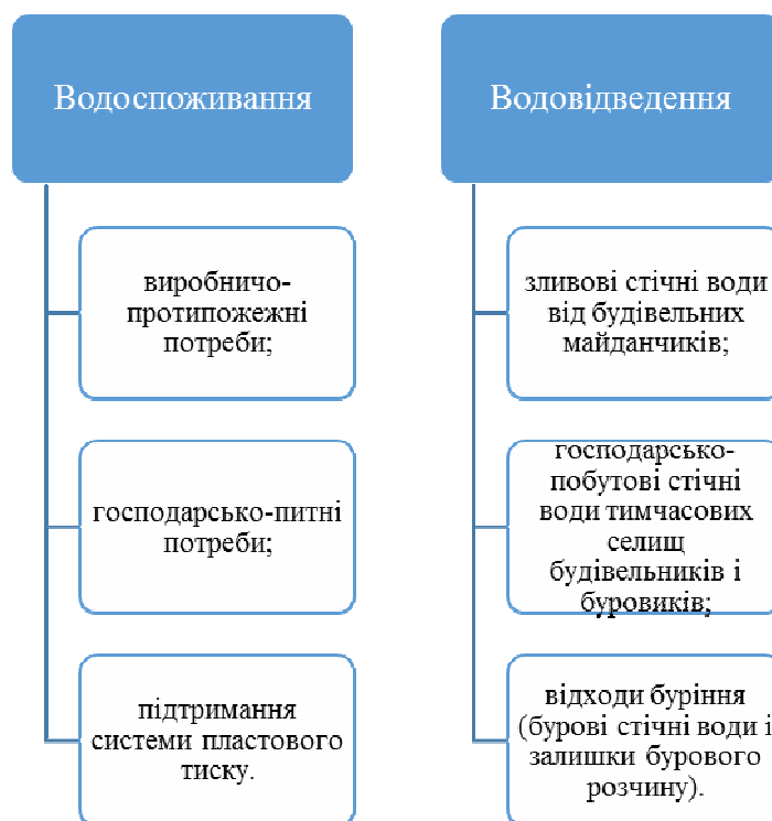
Рисунок Б.1 – Характеристика потреб водопостачання та водовідведення під час будівництва та експлуатації свердловин
