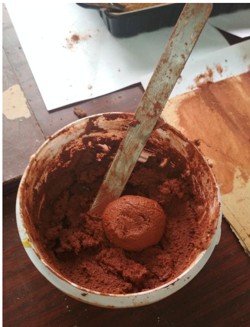
Рис. Б.5. Визначення маслоємності пігменту
