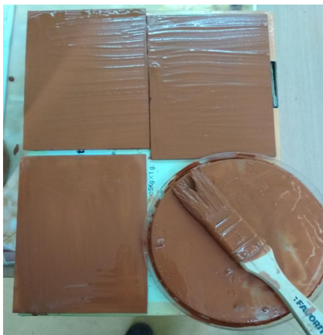
Рис. Б.6. Визначення покривності 50 % розчину пігменту
