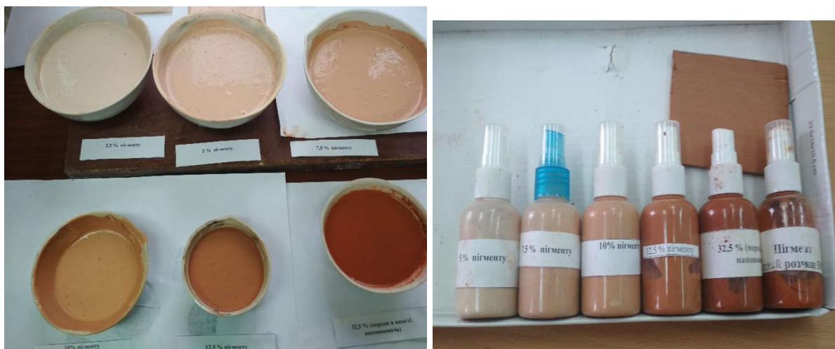
Рис. 2.6. Зразки фарби з різним вмістом пігменту
