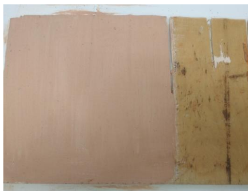
Рис.2.10. Фарбували фанери водно-дисперсійною фарбою
