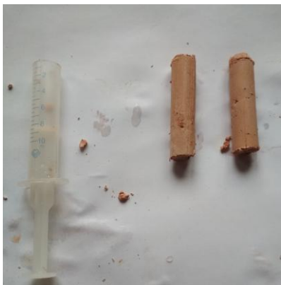
Рис.2.11. Виготовлення мілків за допомогою шприця
