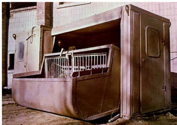
Штукатурна станція СШ-4
