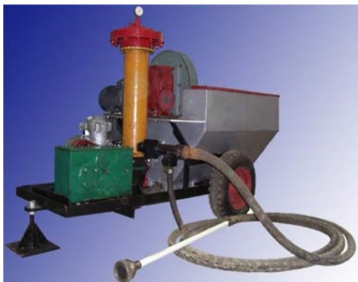
Mobile mortar mixer URZ-3,8
