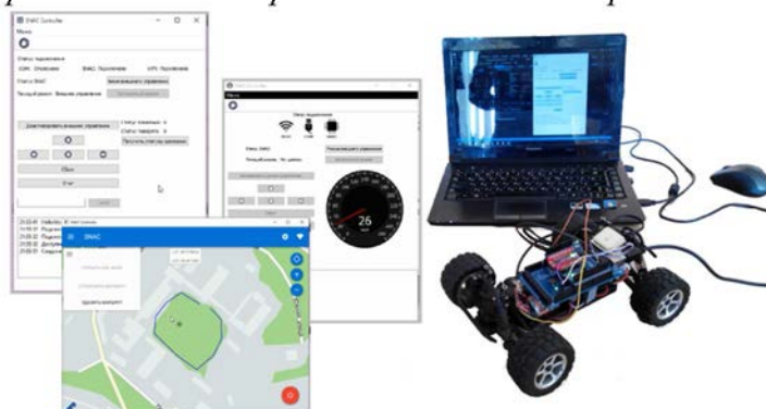
Модель установки для нанесення дорожньої розмітки з супутниковою радіонавігаційною системою орієнтації
