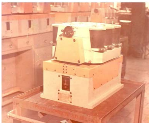
ВЕРСТАТ ВІО-8 з гвинтовою структурою вібраційного поля для фінішної обробки дрібних металевих деталей у середовищі вільного абразиву
