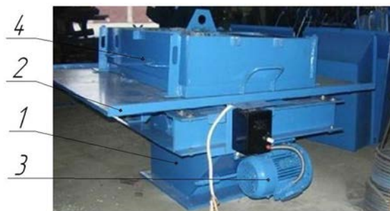
1 – нерухома рама; 2 – рухома рама; 3 – електродвигун; 4 – форма Ударно-вібраційна установка УА-6
