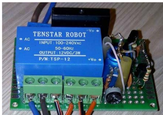
Уніфікований датчик включення освітлення
