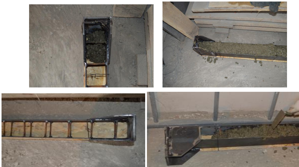
Рис. 2.7. Процес заповнення зразків бетоном
