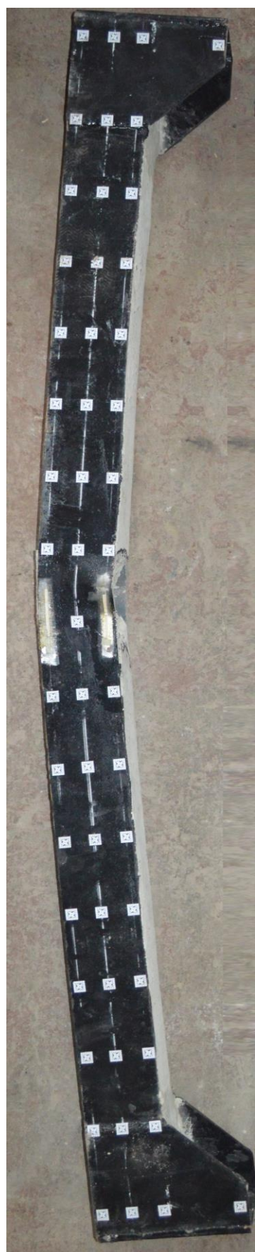
Рис. 4.29. Модель завантажена з ексцентриситетом 50 мм
