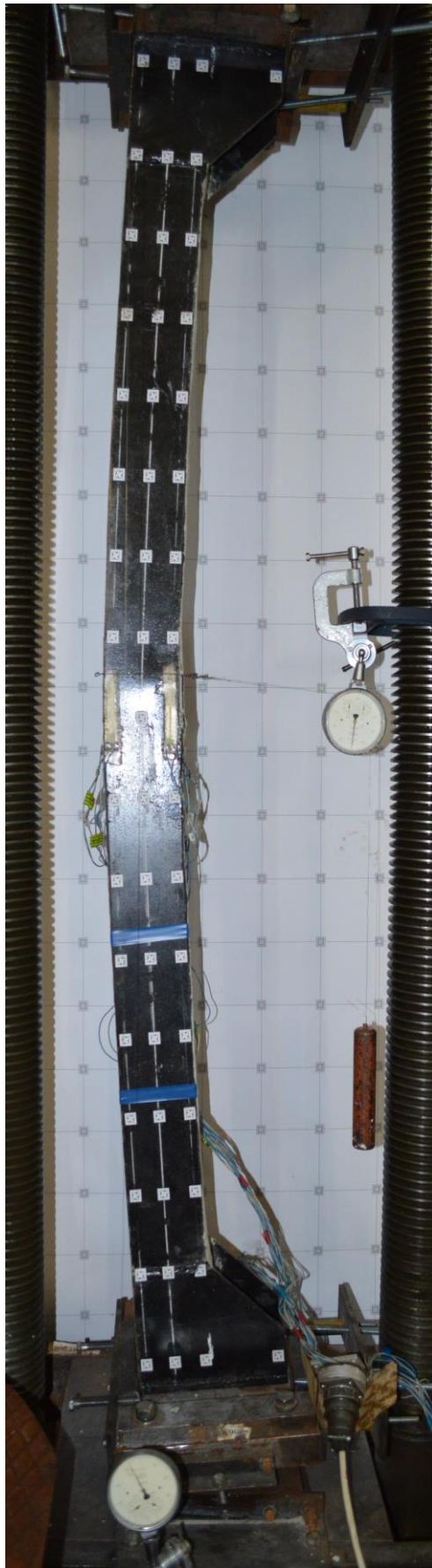
Рис. 4.29. Модель завантажена з ексцентриситетом 50 мм
