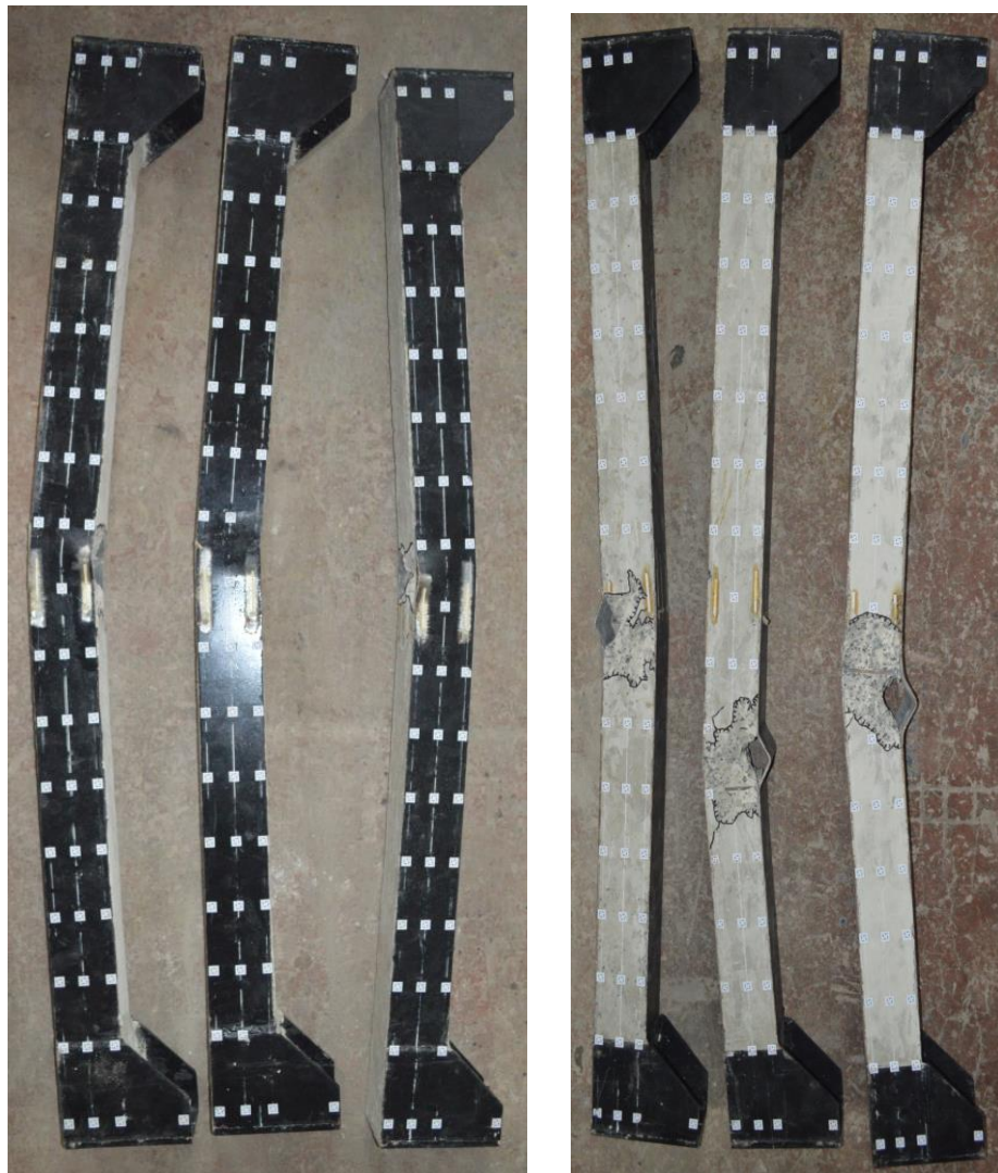
Рис. 3.5. Характер руйнування дослідних сталобетонних зразків серії СБ-ПД-17-1..3 та СБ-ПН-17-1..3
