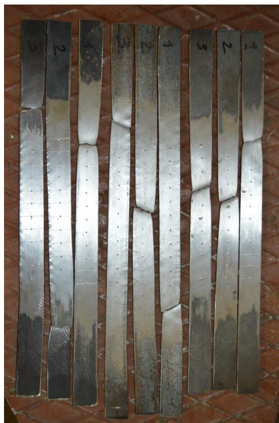
Рис. 2.24. смужки сталі після і до випробовування
