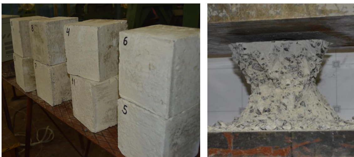
Рис. 2.23. Бетонні куби під час випробовування
