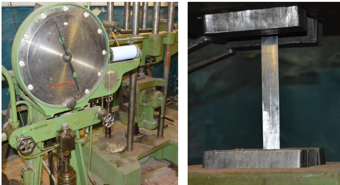
Рис. 2.9. Випробування смужок сталі
