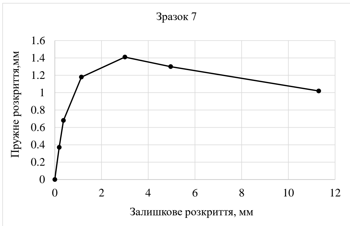
Рис. В.2. Графік залежності між пружною та залишковою деформаціями розкриття фальцевого замку за цикл
