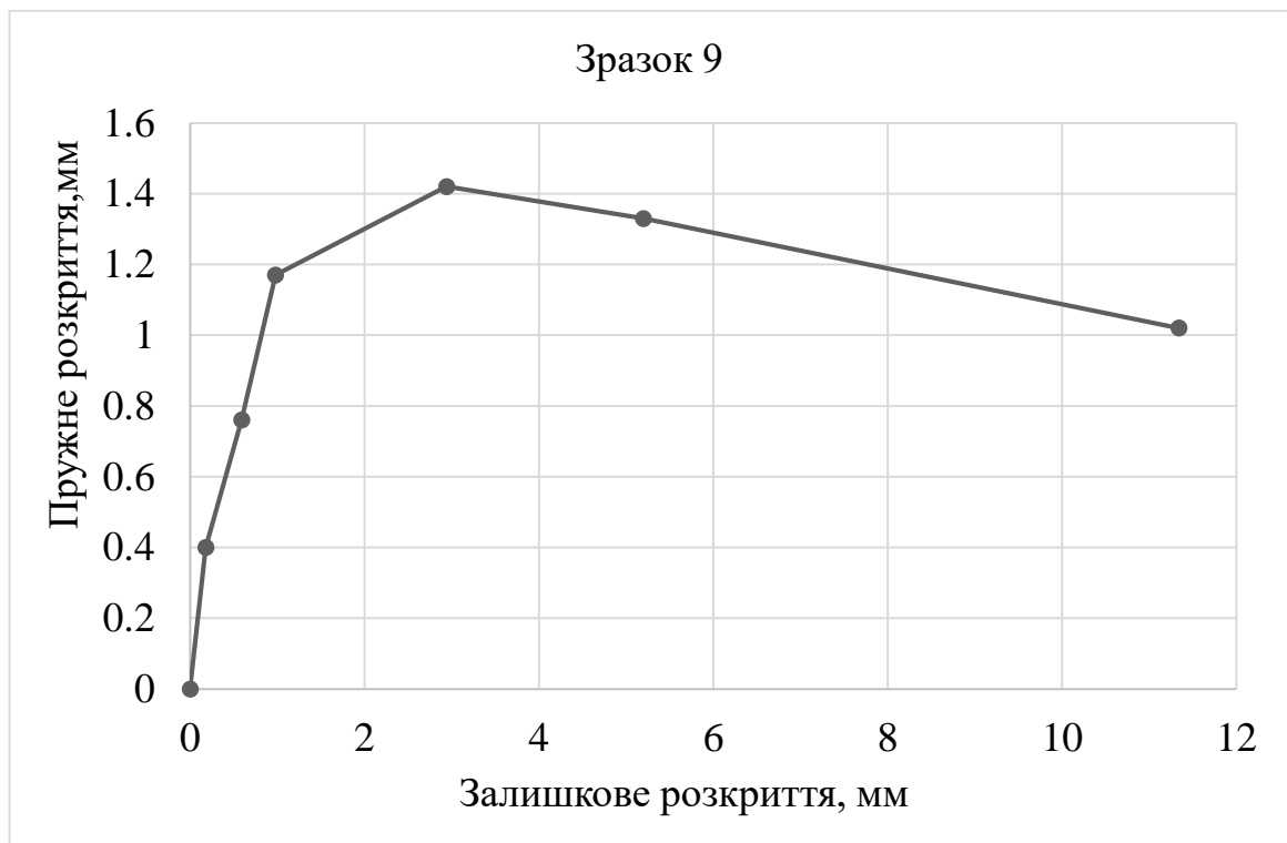
Рис. В.2. (продовження). Графік залежності між пружною та залишковою деформаціями розкриття фальцевого замку за цикл
