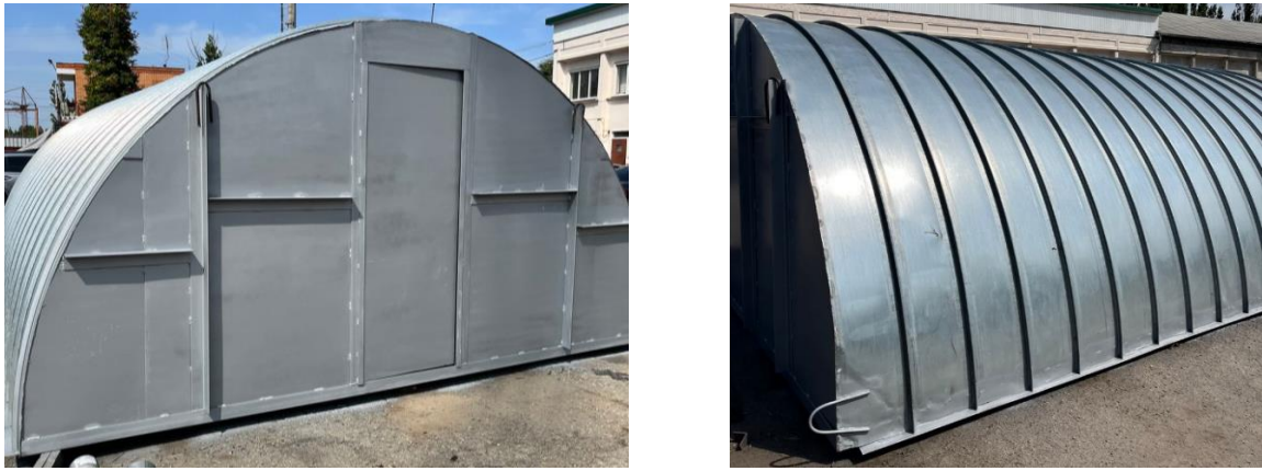
Рис. 2.23. Конструкція бункера-сховища, готова до транспортування
