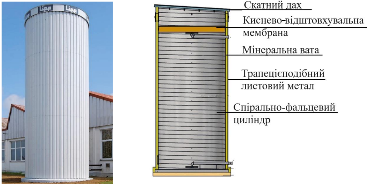
Рис. 2.20. Спірально-фальцевий теплоакumuлюючий бак
