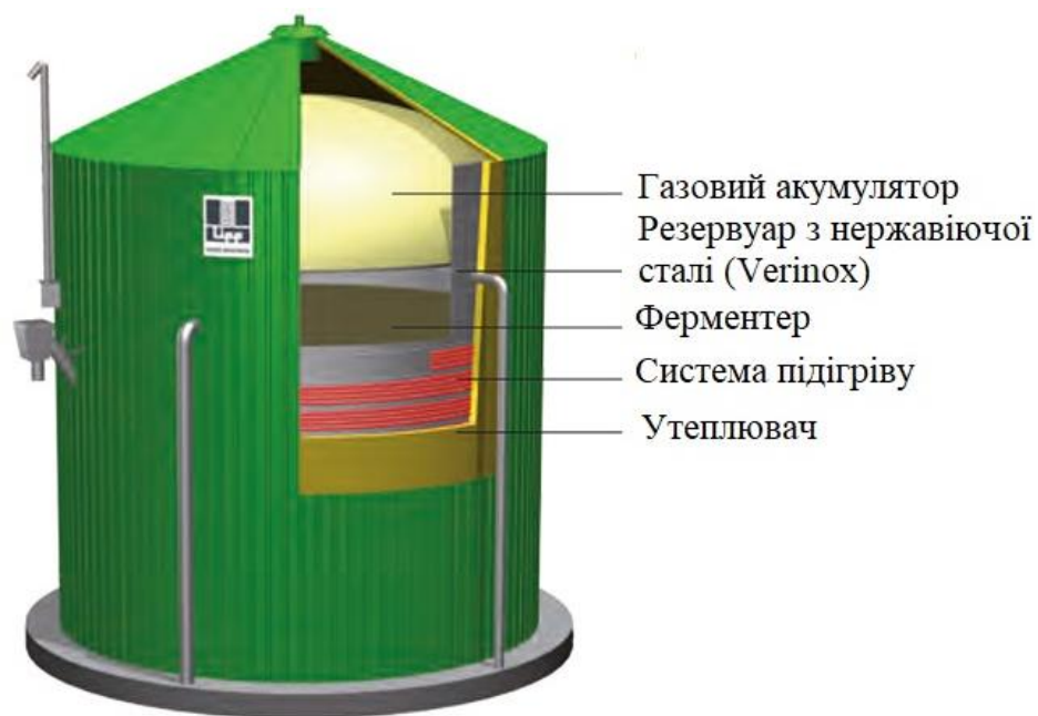
Рис. 2.14. Модульний реактор KomBio із вбудованим газовим акумулятором
