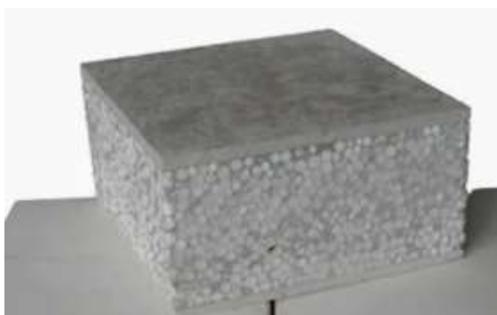
Рисунок 2.1 – Полістиролбетонна стінова панель
