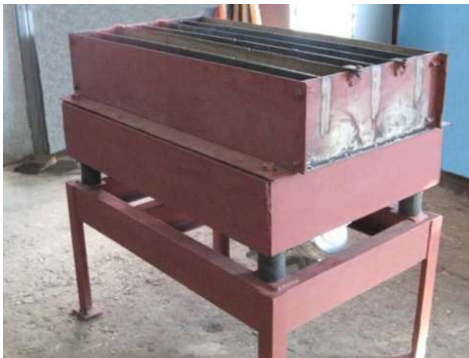
Рисунок 1.12 – Віброустановка для формування малогабаритних бетонних та залізобетонних виробів у касетній формі [108]
