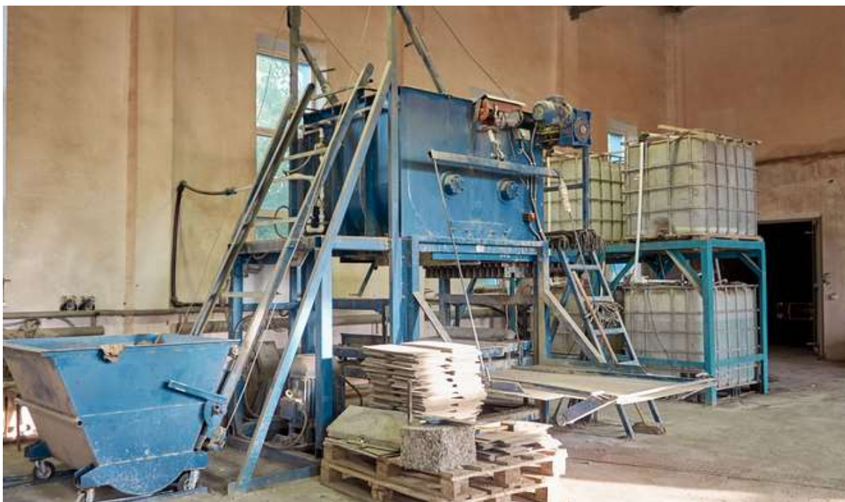
Рисунок 1.14 – Комплект обладнання для ущільнення арболітових блоків
