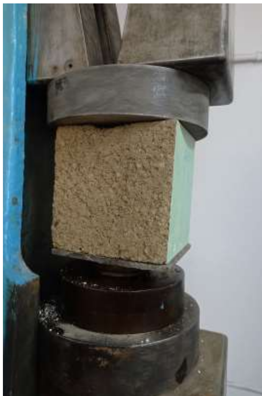
Рисунок 3.12 – Експериментальні дослідження міцності зразків на стиск
