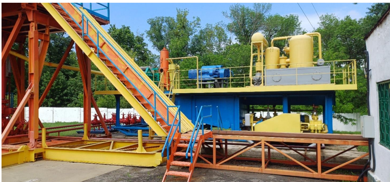
Рисунок 4.2 – Мобільної бурова установка KREMCO K-750 (циркуляційна система) Національного університету «Полтавська політехніка імені Юрія Кондратюка»
