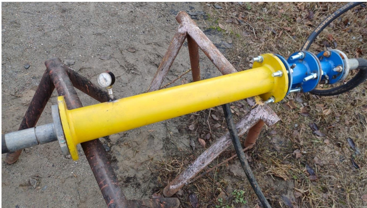
Рисунок 5.3 – Удосконалений піногенератор на випробуваннях
