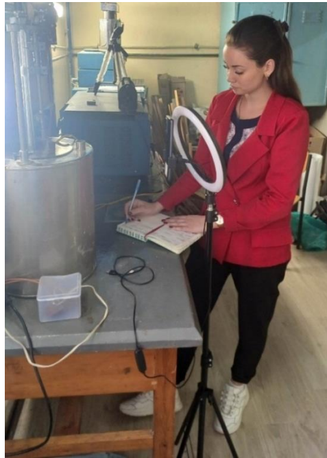
Рис. 3.8 – Зняття показів температури за термометром Бекмана для калібрування калориметру
