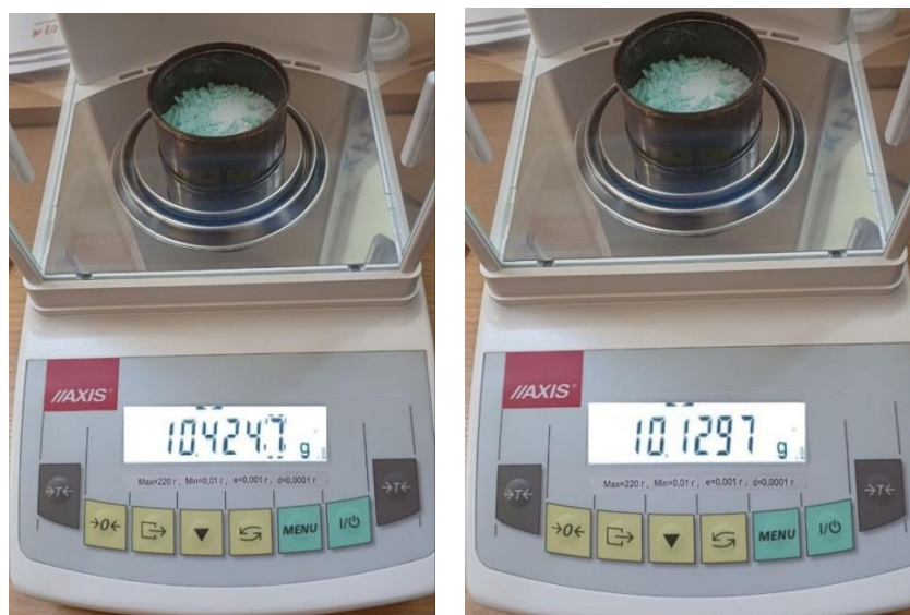
Рис. 3.5 – Маса досліджуваного пластику (поліпропілену) до (а) та після (б) висушування
