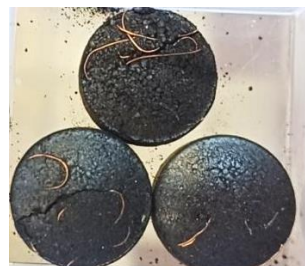
а) стандартизовані «таблетки» з впресованим мідним дротом
