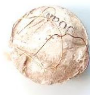
а) стандартизовані «таблетки» з впресованим мідним дротом
