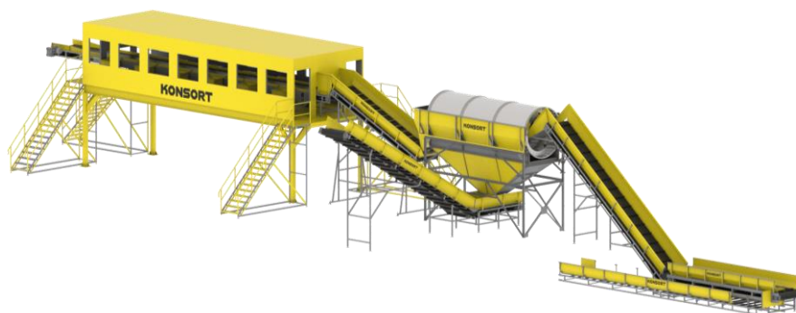
Рис. 4.12 – Сортувальна лінія потужністю до 50 000 тонн ПВ на рік Джерело: [177].
