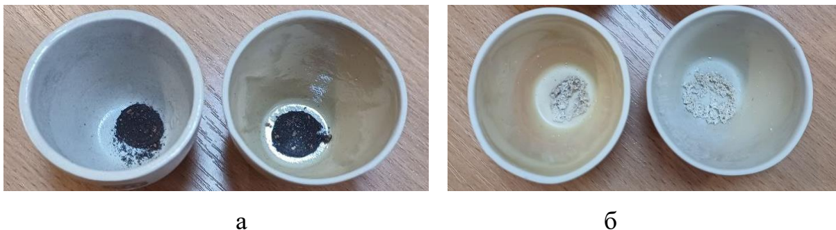
Рис. 3.5 – Вміст золи після прожарювання торфу (а) та паперу глянцевого (б)
