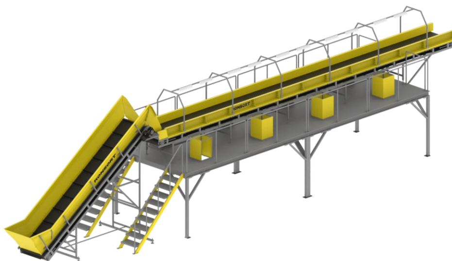
Рис. 4.13 – Сортувальна лінія потужністю до 10 000 тонн ПВ на рік Джерело: [178].
