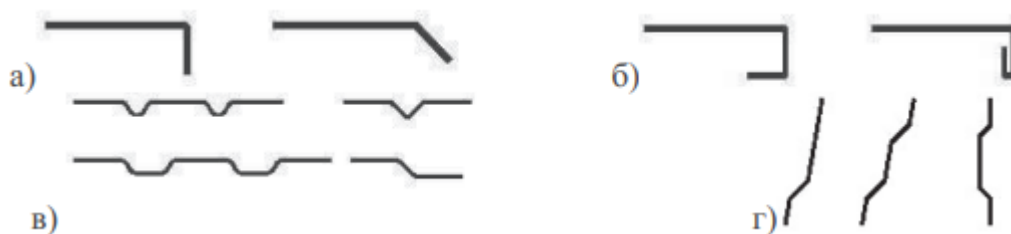
Рис. 1.1.6 – Форми елементів жорсткості для холодноформованих елементів та настилів [129]: а, б – крайові елементи жорсткості; в – проміжні елементи жорсткості полиць; г – проміжні елементи жорсткості стінок
