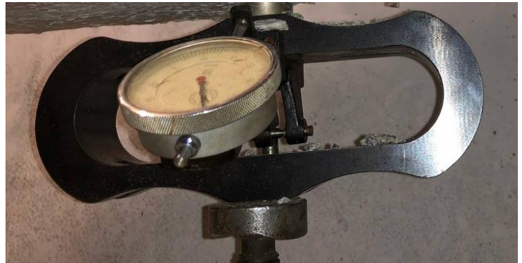
Рис. 3.2.6 – Загальний вигляд механічного відтарованого динамометру типу ДОСМ-2
