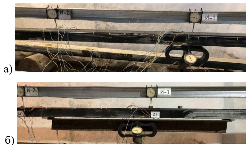
Рис. 3.2.14 – Розташування індикаторів годинникового типу для вимірювання прогинів балок при завантаженні однією силою по центру прольоту (а) та двома силами, рівновіддаленими від опор (б)
