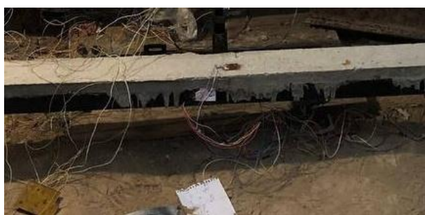
Рис. 3.2.12 – Розміщення електротензорезисторів на бетонній частині перерізу посередині прольоту (а) та у чвертях прольоту (б)
