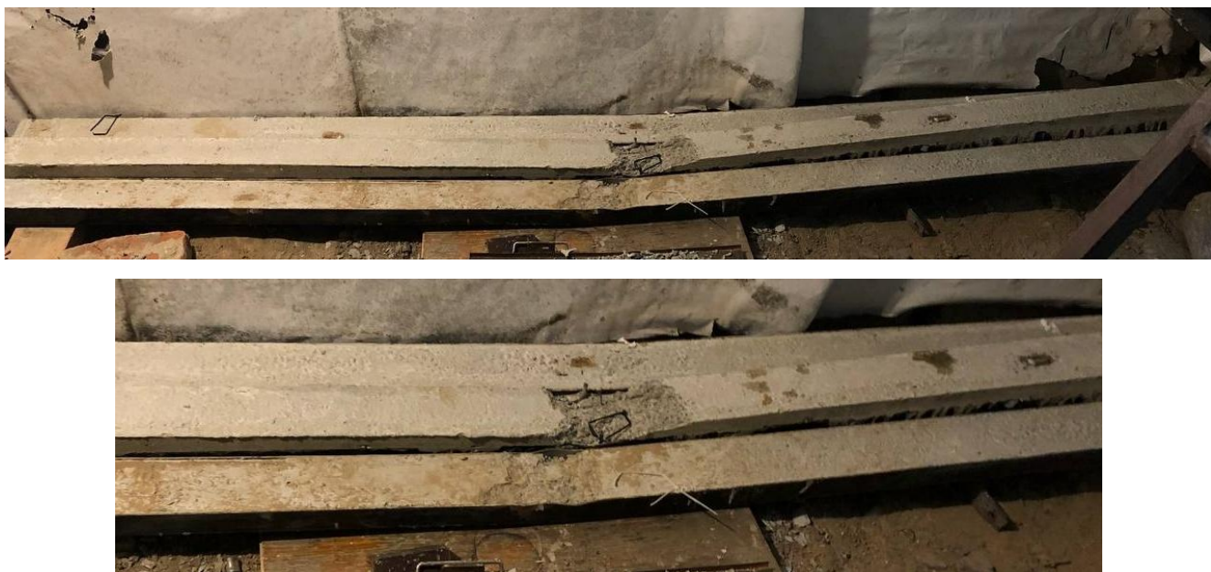
Рис. 3.4.7 – Загальний вигляд зразків після руйнування
