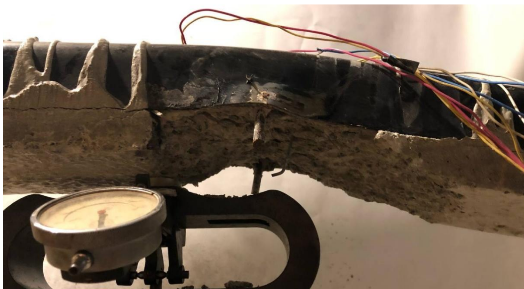
Рис. 3.4.6 – Втрата стійкості стиснутої зони полиць сталевих холодноформованого швелеру
