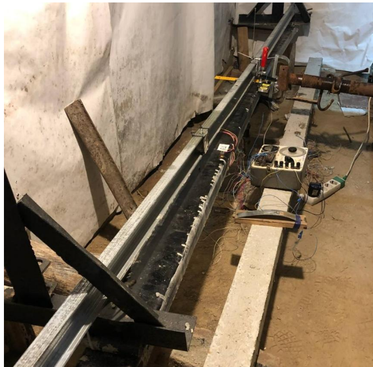
Рис. 3.5.3 – Загальний вигляд сталобетонних прогонів під час проведення випробувань на косий згин
