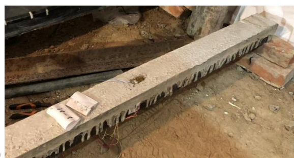
Рис. 3.2.12 – Розміщення електротензорезисторів на бетонній частині перерізу посередині прольоту (а) та у чвертях прольоту (б)
