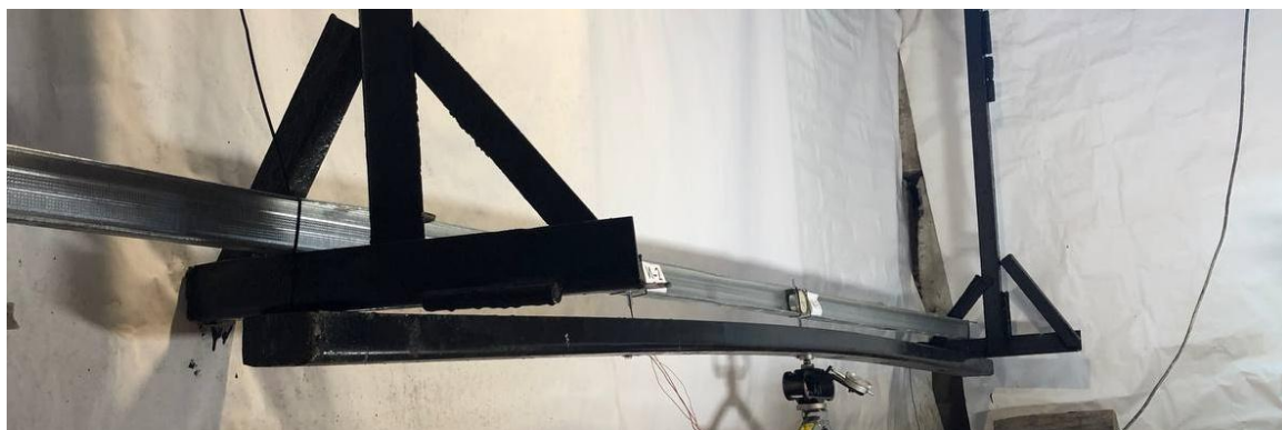
Рис 3.1.7 – Сталева частина з гнутого швелеру №10 зразків холодноформованих сталезалізобетонних конструкцій
