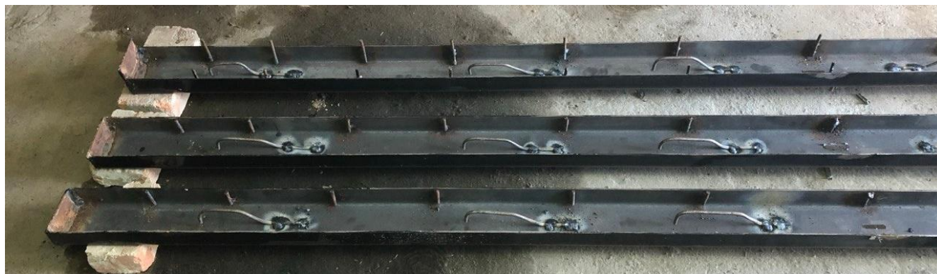
Рис. 3.1.4 – Загальний вигляд сталеві частини зразків із привареними вертикальними зв'язками та S-подібними анкерами
