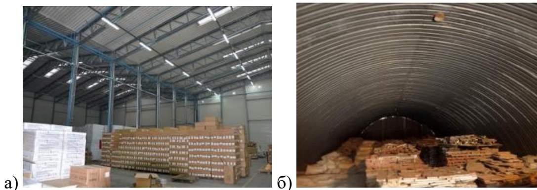
Рис. 1.1.7 – Типологія швидкокомтованих споруд виробничо-складського призначення на базі гнутих профілів: а – конструктивна схема двопролітної рамної системи; б – безкаркасна аркова оболонка, сформована з профільованого настилу
