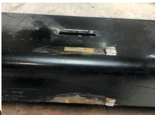
Рис. 3.2.11 – Розміщення електротензорезисторів на сталевому профілю посередині прольоту (а) та у чвертях прольоту (б)
