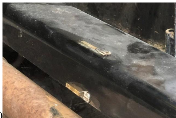
Рис. 3.2.11 – Розміщення електротензорезисторів на сталевому профілю посередині прольоту (а) та у чвертях прольоту (б)
