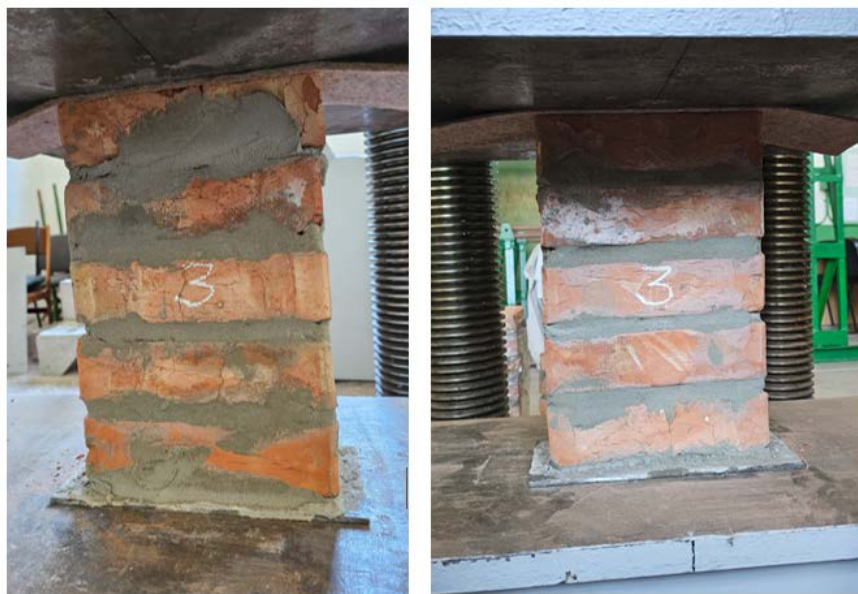
Рисунок 2.7 – Дослідний зразок П-25.12.36,5-а в пресі перед випробуванням
