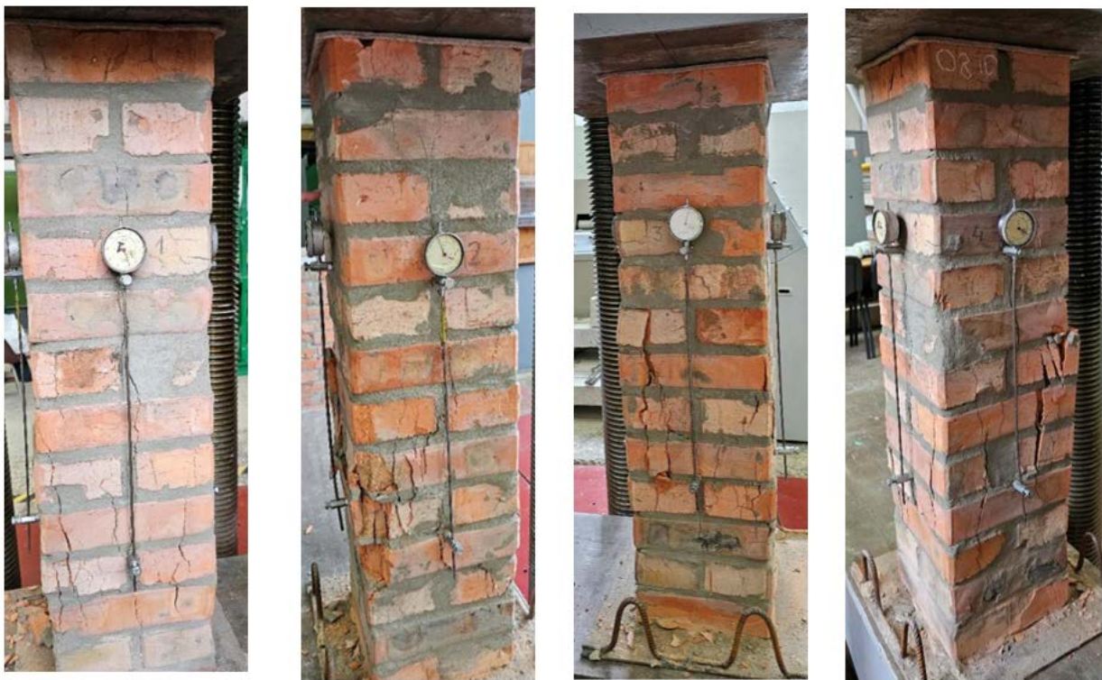
Рисунок 3.1 – Дослідний стовпчик С-25.25.100 після випробування
