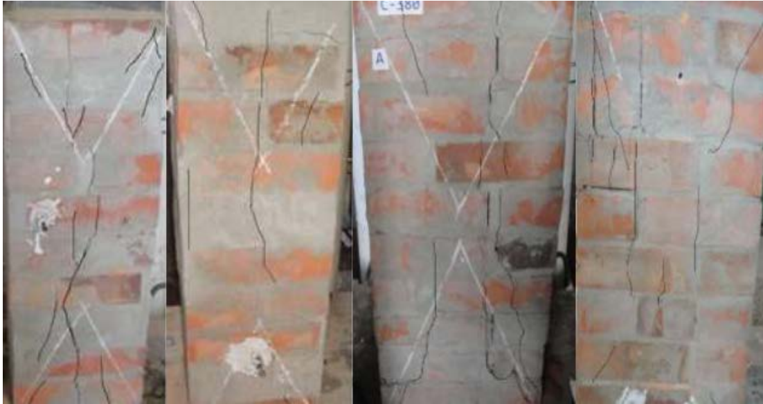
Рисунок 1.12 – Характер руйнування дослідних зразків
