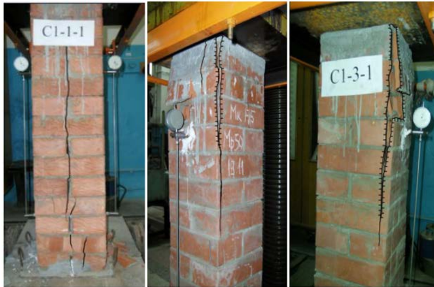
Рисунок 1.9 – Характер руйнування цегляних стовпів
