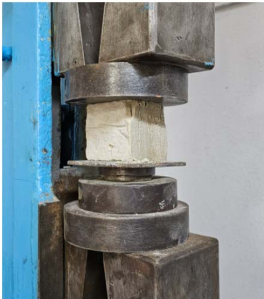
Рисунок 2.11 – Процес випробування кубів розчину
