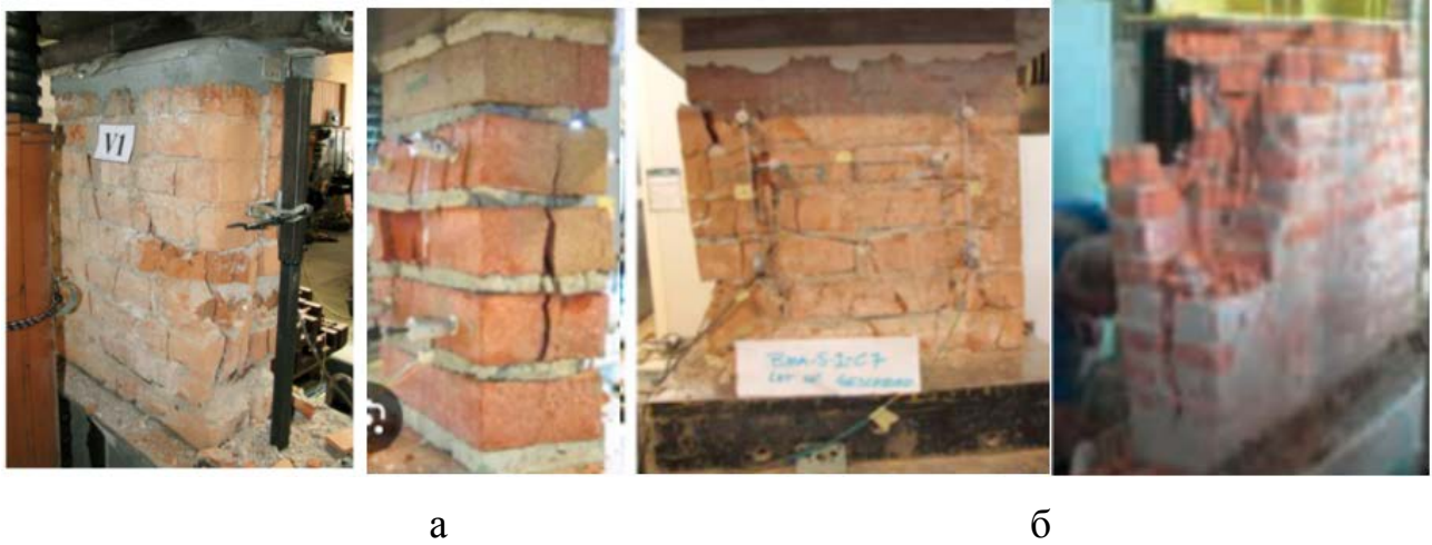
Рисунок 3.7 – Характер руйнування стінок при осьовому стиску в дослідях:
