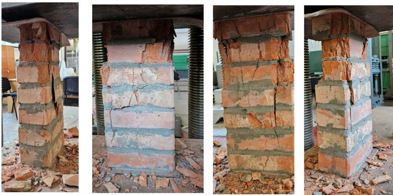
Рисунок 3.12 – Дослідний зразок П-25.12.51,5-а після випробування
