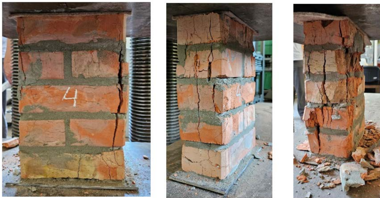
Рисунок 3.11 – Дослідний зразок П-25.12.36,5-б після випробування
