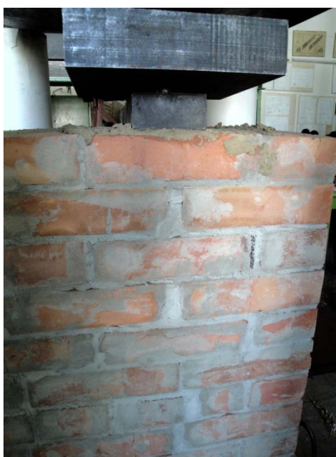
Рисунок 2.13 – Зразок Ст(м)-1-1 у пресі перед випробуванням
