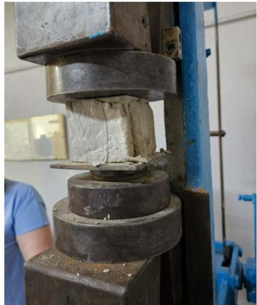
Рисунок 2.11 – Процес випробування кубів розчину
