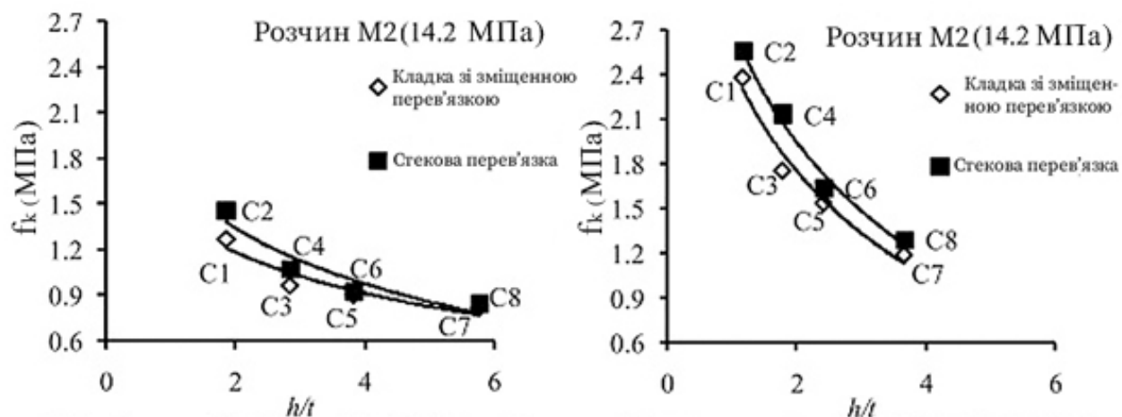
Рисунок 1.18 – Зміна опору призми на стиск зі зміною співвідношення h/t :
