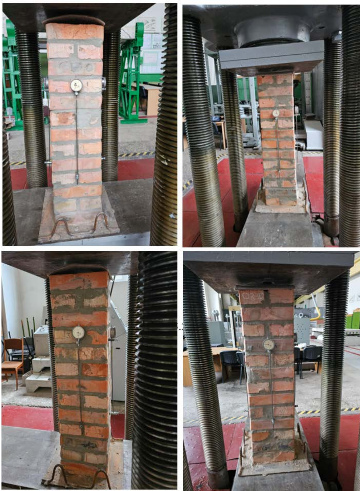
Рисунок 2.5 – Дослідний зразок С-25.25.100 в пресі перед випробуванням
