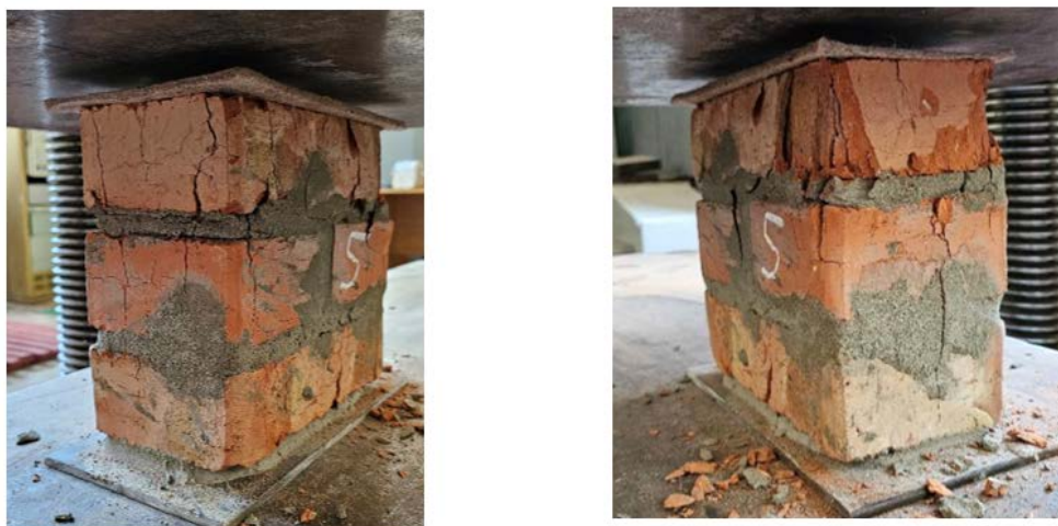
Рисунок 3.8 – Дослідний зразок П-25.12.21,5-а після випробування
