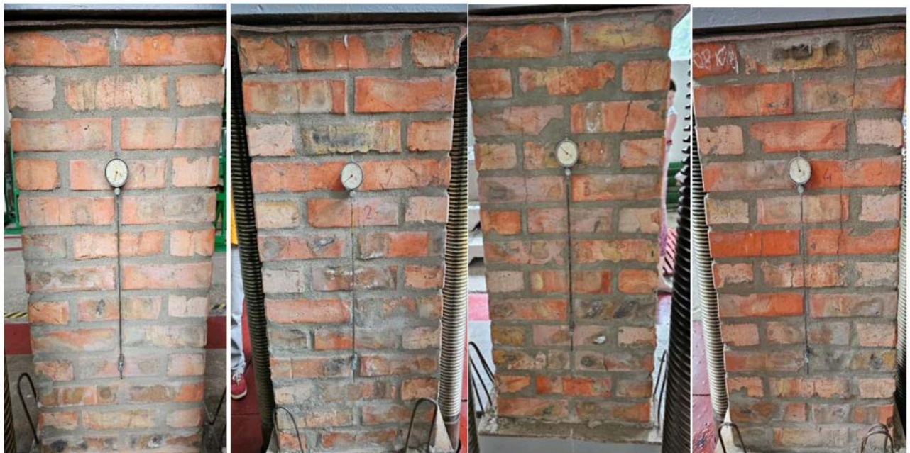
Рисунок 3.3 – Утворення тріщин дослідного зразка С-51.51.100
