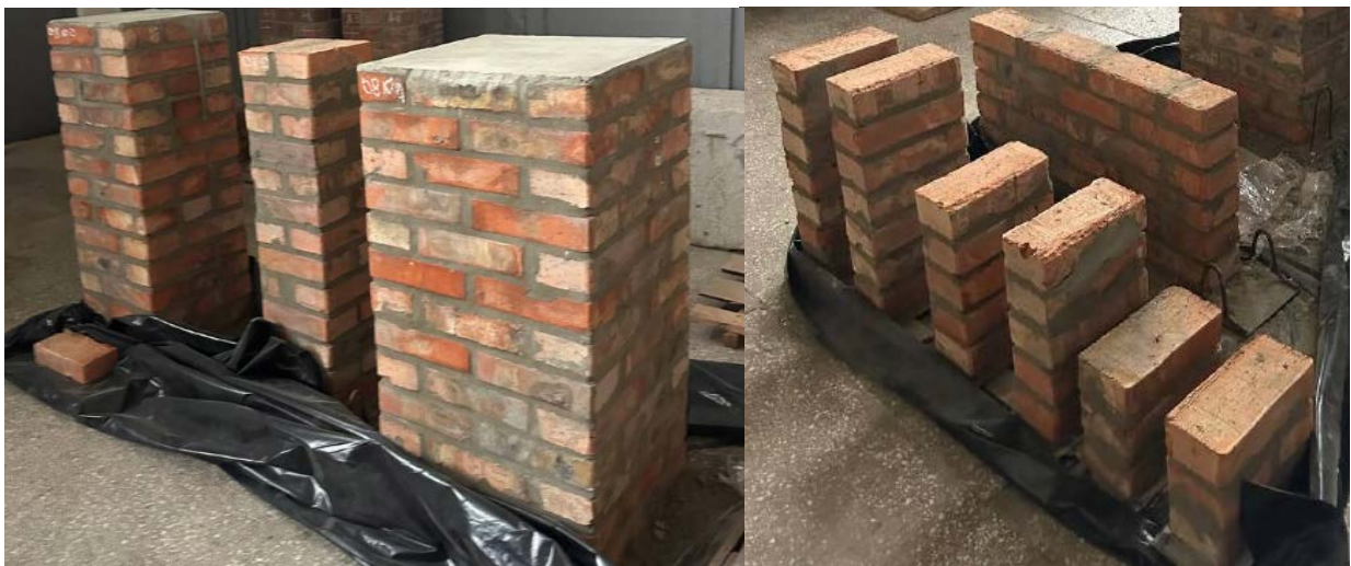
Рисунок 2.1 – Дослідні зразки для випробування на осьовий стиск
