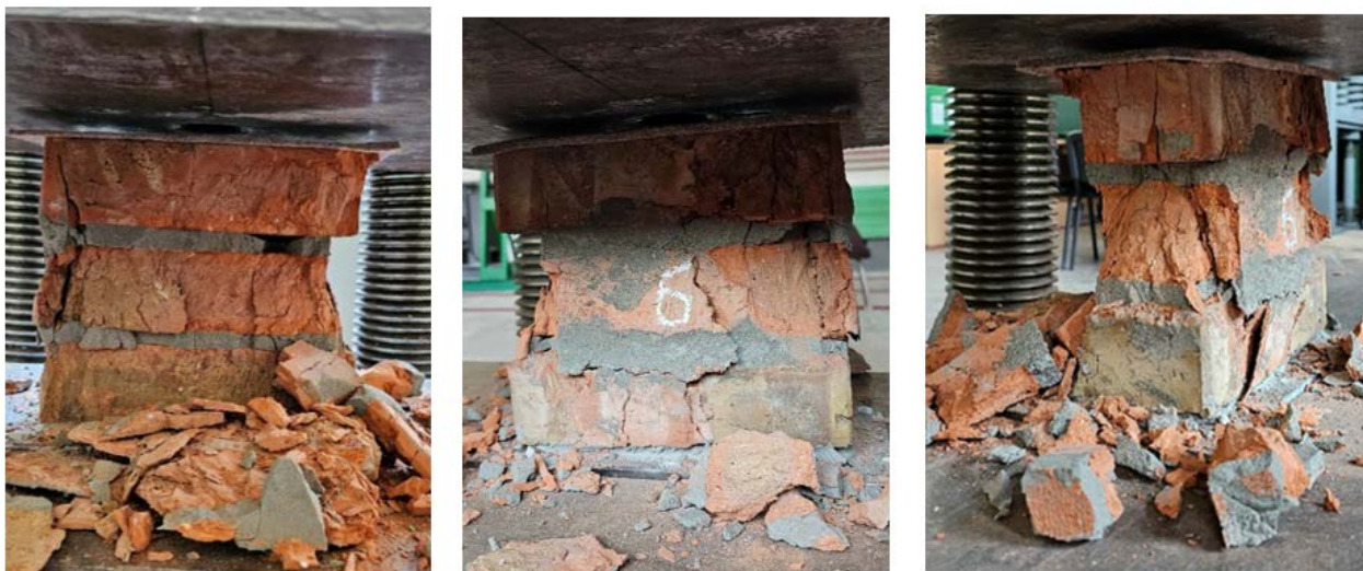
Рисунок 3.9 – Дослідний зразок П-25.12.21,5-б після руйнування
