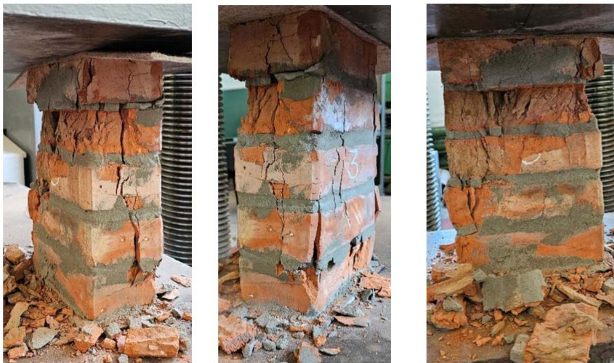
Рисунок 3.10 – Дослідний зразок П-25.12.36,5-а після випробування
