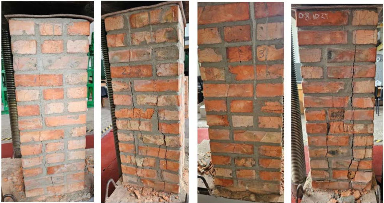
Рисунок 3.2 – Дослідний зразок С-38.38.100 після випробування
