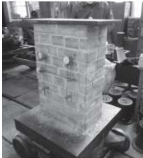
Рисунок 1.13 – Зразок без горизонтальних тріщин після руйнування на центральний стиск
