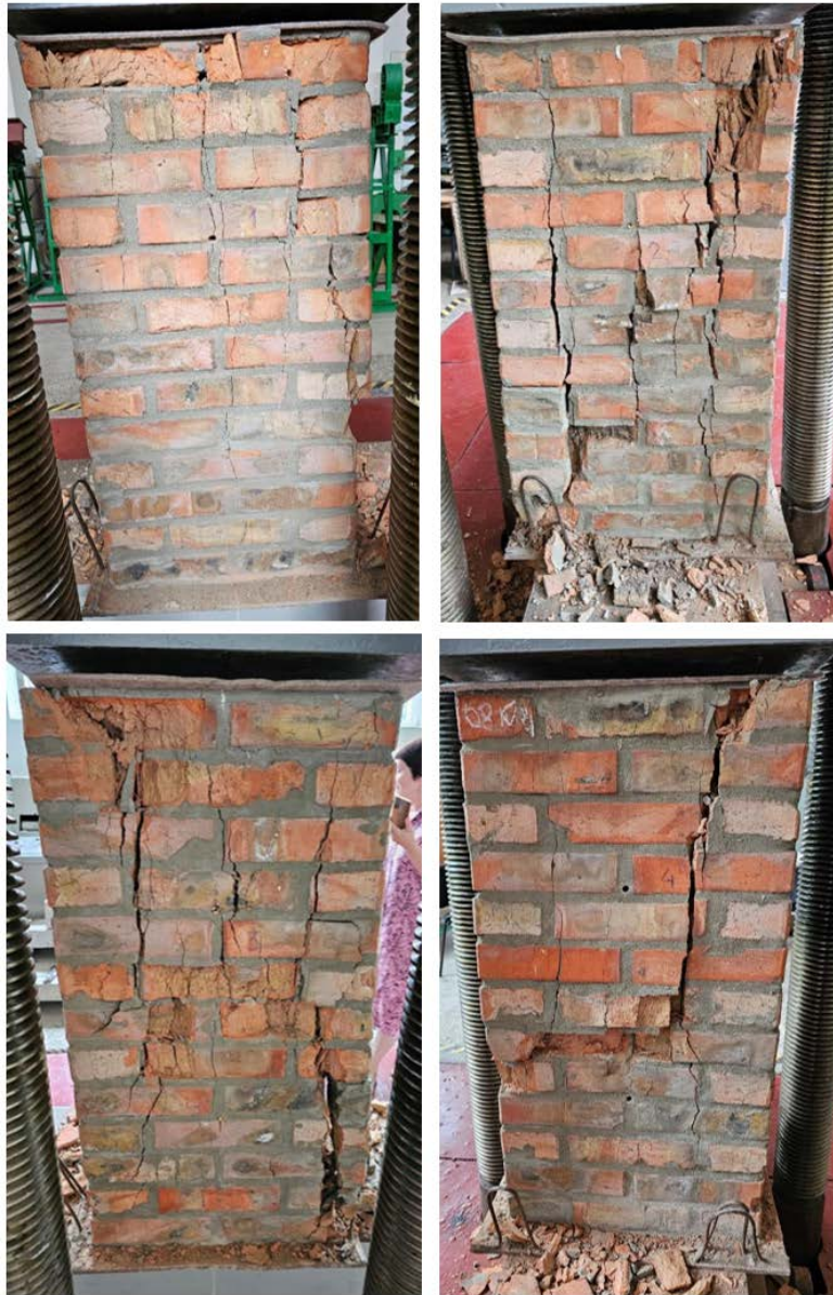
Рисунок 3.4 – Дослідний зразок С-51.51.100 після випробування
