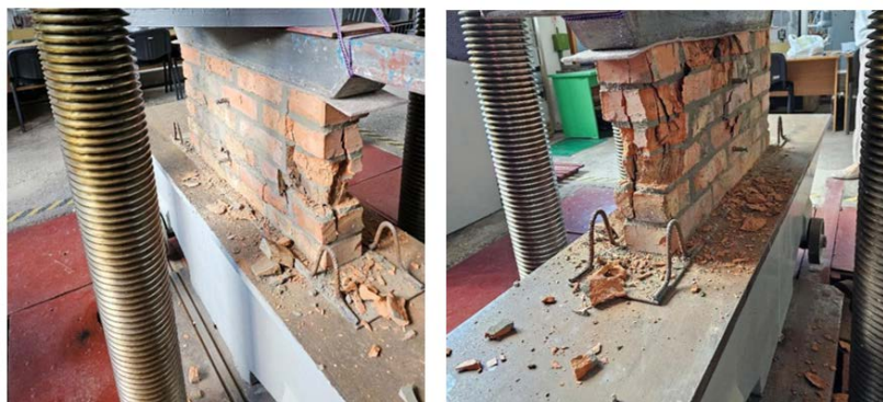
Рисунок 3.6 – Дослідний зразок Ст-90.12.44 після випробування
