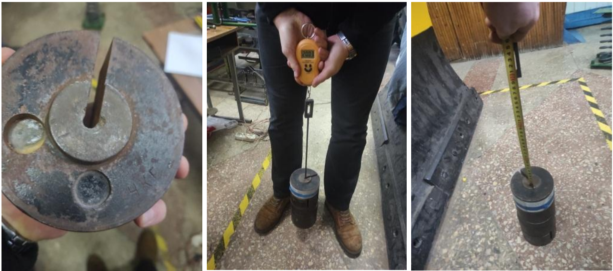
Рисунок 3.24 – Підготовка вагових тягарців для проведення експериментальних досліджень
