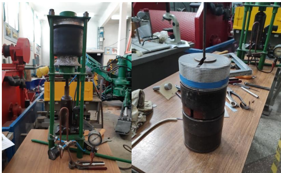
Рисунок 3.6 – Експериментальний стенд дослідження повздовжніх деформацій пневмобалона та набір тягарців на штанзі
