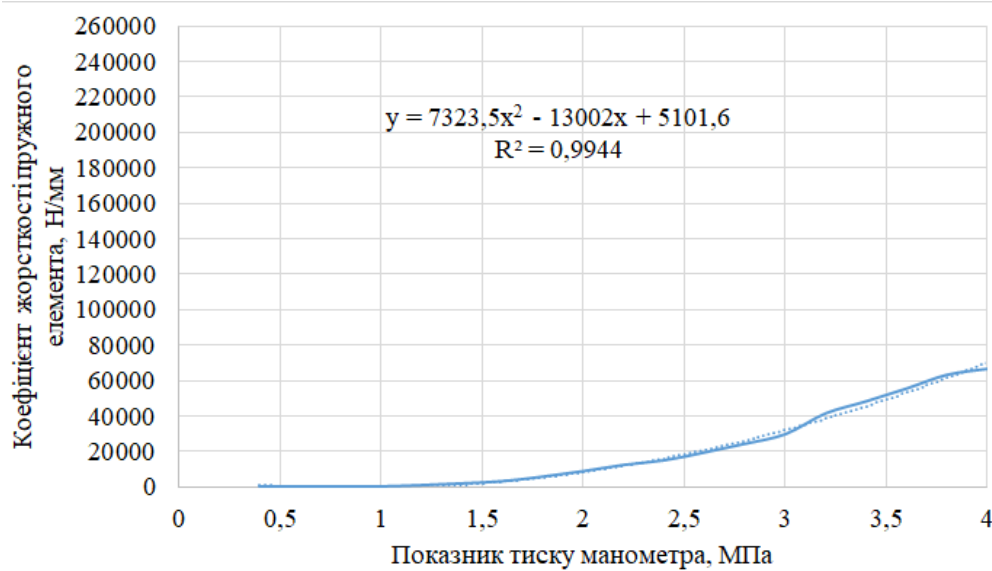
Рисунок 3.23 – Експериментальні дані коефіцієнта жорсткості пневмобалона, як замкненої камери компенсатора при тиску ( P_B=0,25 МПа).
