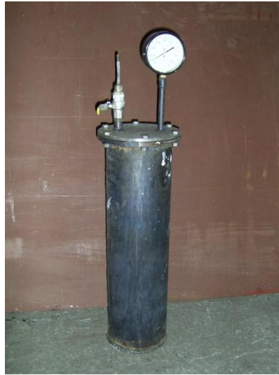
Рисунок 3.8 – Стенд дослідження насичення повітрям вільної камери компенсатора
