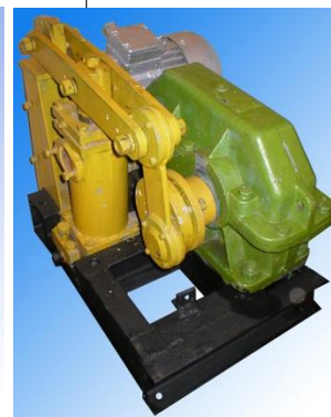
Рисунок 1.4 – Принципові схеми та зображення однопоршневих диференціальних розчинонасосів: а – одноплунжерний; б – РН 2-4; в – РН 3,8
