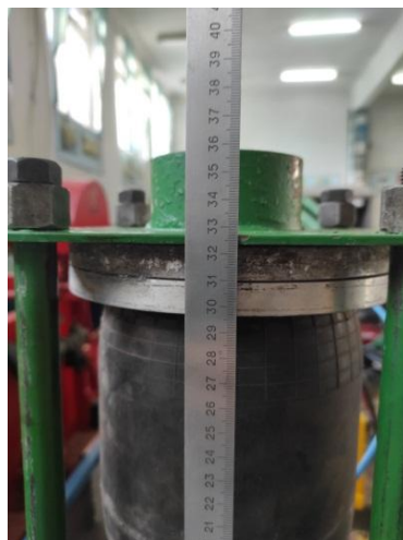
Рисунок 3.7 – Визначення початкових лінійних розмірів пружних елементів
