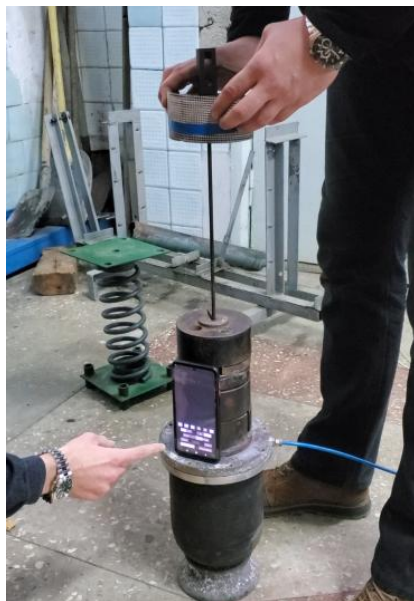
Рисунок 3.25 – Процес зняття діаграм затухання.
