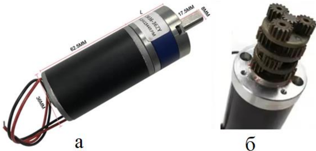
а – габаритні та приєднувальні розміри, б – конструкція планетарної передачі
