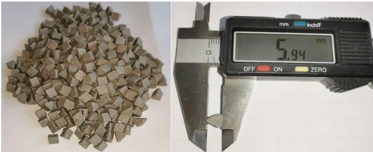
Рисунок 3.7 – Абразивні тіла TR 25A 10 CT1 розміром 6х6х6 (мм)
