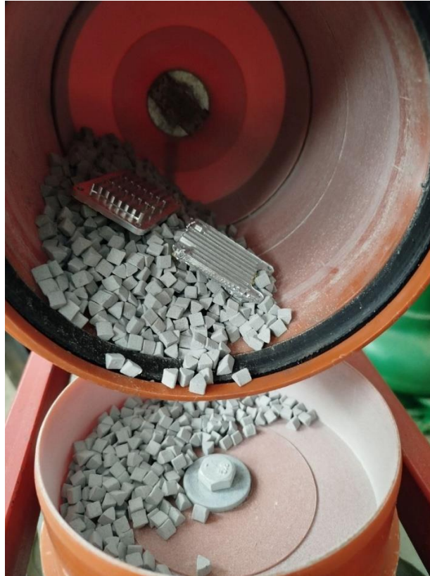
Рисунок 4.7 – Завантаження радіаторів в робочу камеру дослідної установки
