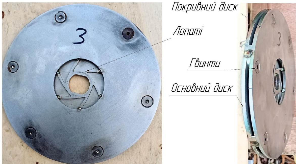
Рисунок 4.2 – Будова робочого колеса насоса ЦНСк 1–20
