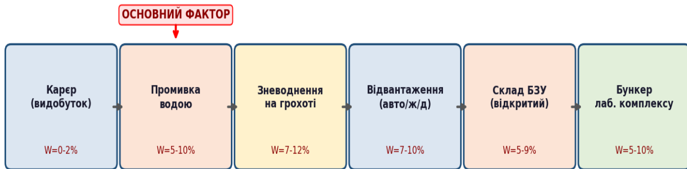
Рис. 3.3. Технологічний ланцюг підготовки промитого заповнювача та зміна вологості W на кожному етапі: мокре промивання є єдиним ключовим технологічним вузлом, що формує підвищену вологість матеріалу
