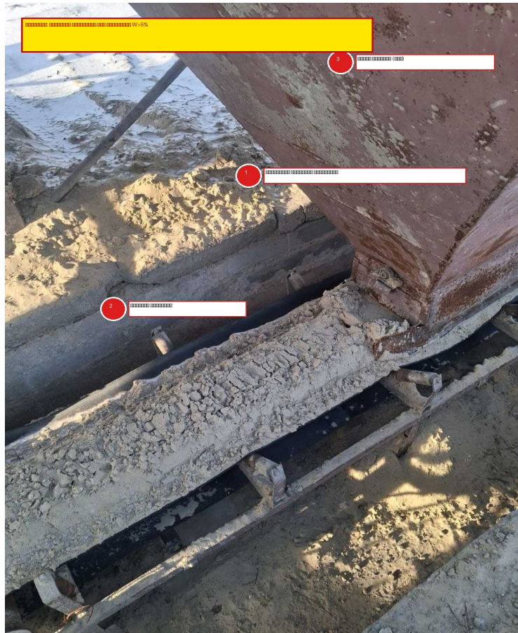
Рис. 3.8. Налипання та злипання вологого піску ( W > 5\% ) на стрічці конвеєра під розвантажувальним отвором бункера.
