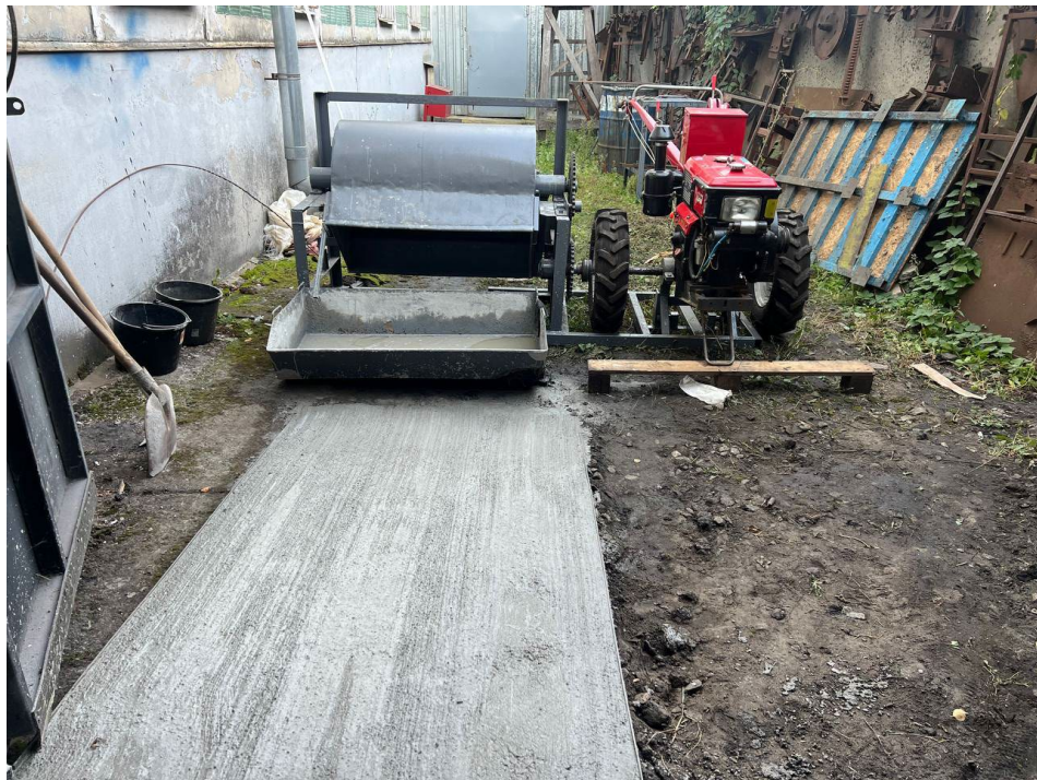
Рисунок 4.2 – Впровадження розчинозмішувача з приводом від валу трансмісії мотоблоку
