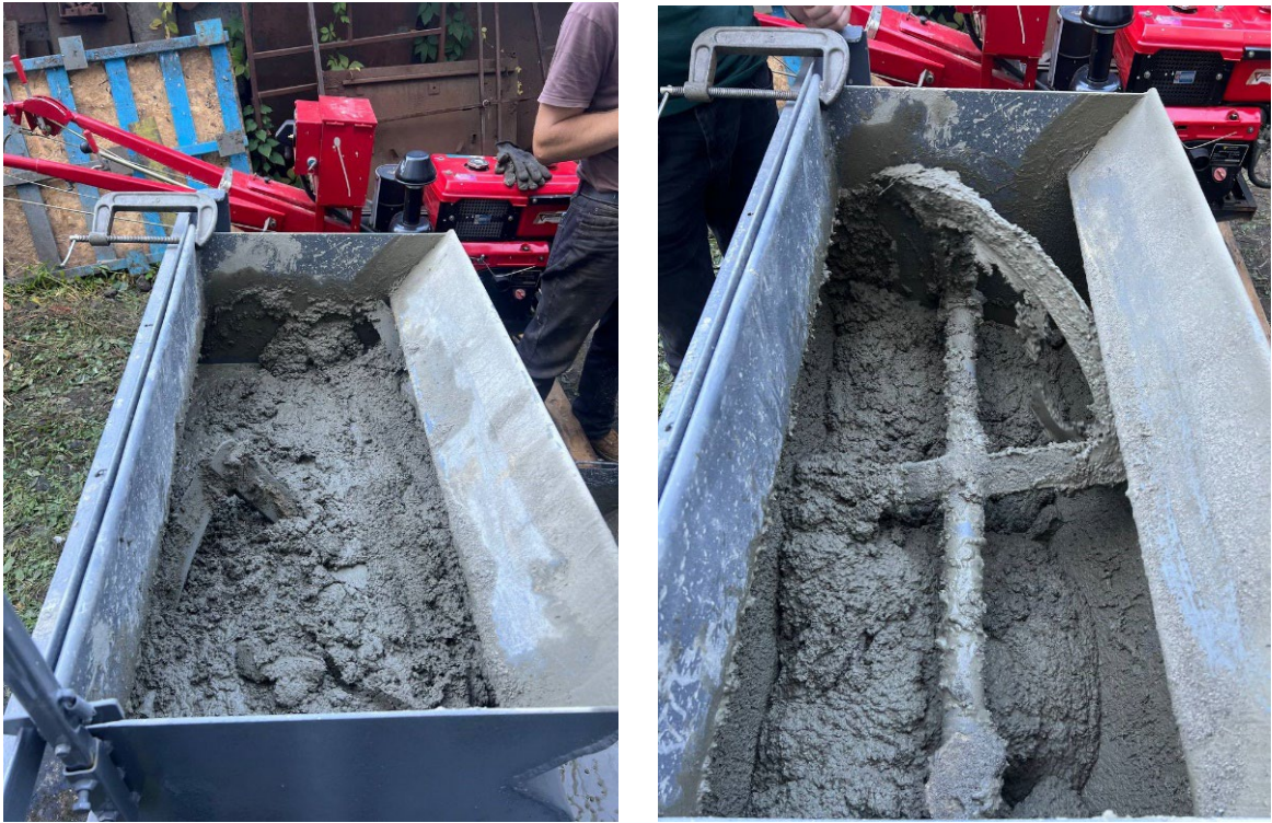
Рисунок 3.8 – Змішування будівельного розчину при різних режимах роботи
