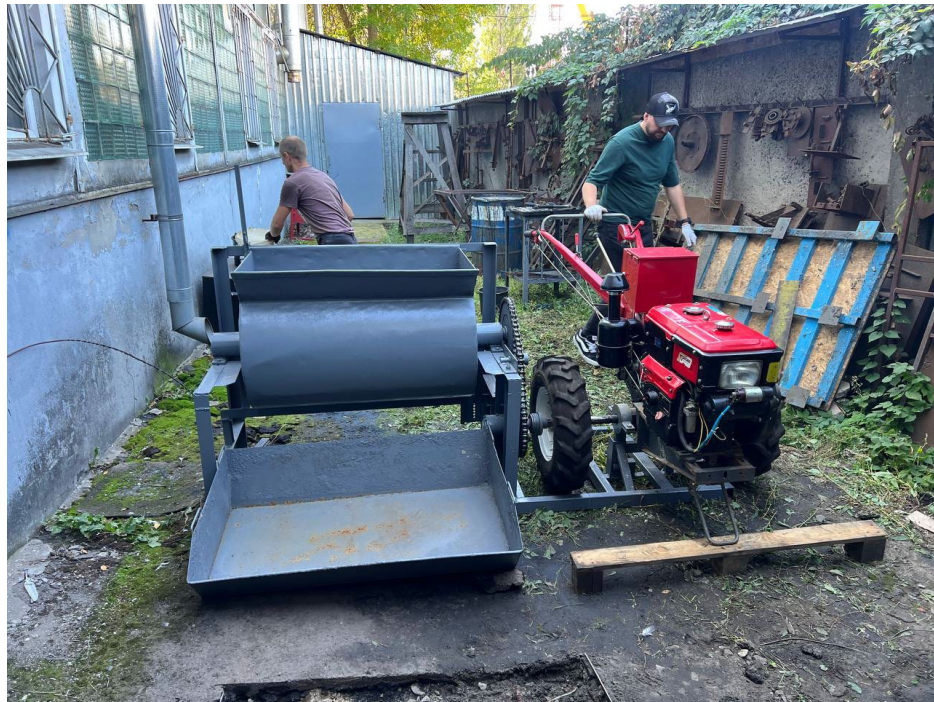
Рисунок 4.1 – Розчинозмішувач з приводом від валу трансмісії мотоблоку
