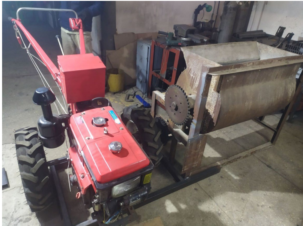
Рисунок 3.1 – Дослідний зразок розчинозмішувача з приводом від валу трансмісії мотоблоку
