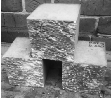
Рисунок 3. Кубики полістиролбетону 100x100x100мм
