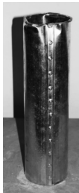
Рисунок 6. Характер руйнування сталеві труби ЦМ40
