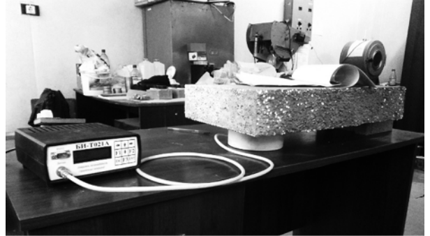
Рисунок 5. Визначення теплопровідності полістиролбетону
