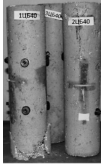
Рисунок 4. Циліндри полістиролбетону 400x100мм
