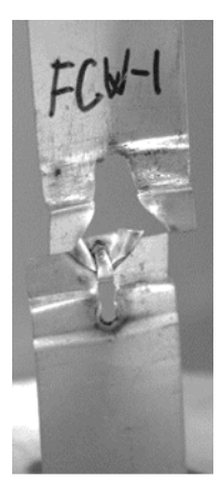
Рисунок 13. З'єднання фальцеве + напівавтоматичне зварювання
