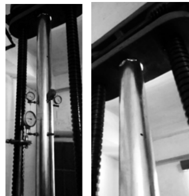
Рисунок 7. Характер руйнування сталеві труби ЦМ150
