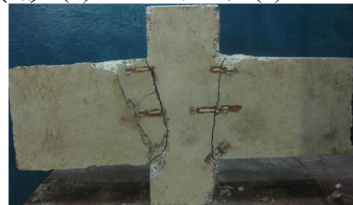
Рисунок 8 – Результати експериментальних досліджень шпонок із одноярусним розташуванням арматури: характер руйнування зразка ША-0,25-П-ПМ-0,357-1а (а); графіки залежностей « V_k/V_{ku} - \varepsilon_c (\varepsilon_{ct}) » (б) і « V_k/V_{ku} - \varepsilon_s » (в)
