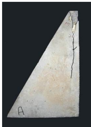
Рисунок 9 – Характер руйнування (І випадок) зрізаних бетонних клинів КЛ1-30-20* та КЛ1-ПМ-30-0 (а) і графіки залежності « P_w/P_{wu} - \varepsilon_c (\varepsilon_{ct}) » (б)
