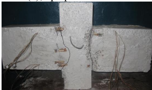
Рисунок 8 – Результати експериментальних досліджень шпонок із одноярусним розташуванням арматури: характер руйнування зразка ША-0,25-П-ПМ-0,357-1а (а); графіки залежностей « V_k/V_{ku} - \varepsilon_c (\varepsilon_{ct}) » (б) і « V_k/V_{ku} - \varepsilon_s » (в)
