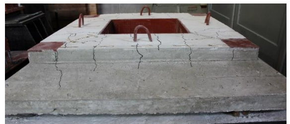
Рис. 6. Розподіл тріщин на верхній розтягнутій поверхні зразка серії ПНК
