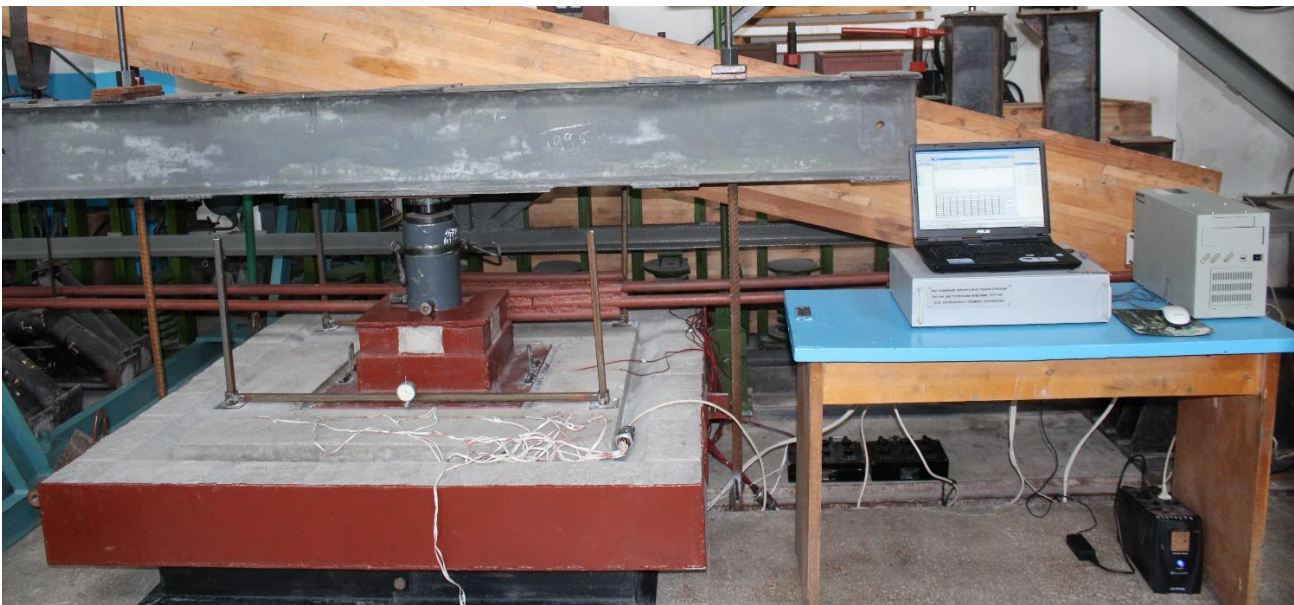
Рис. 4. Схема розташування вимірювальних приладів на дослідних зразках серії ПНК
