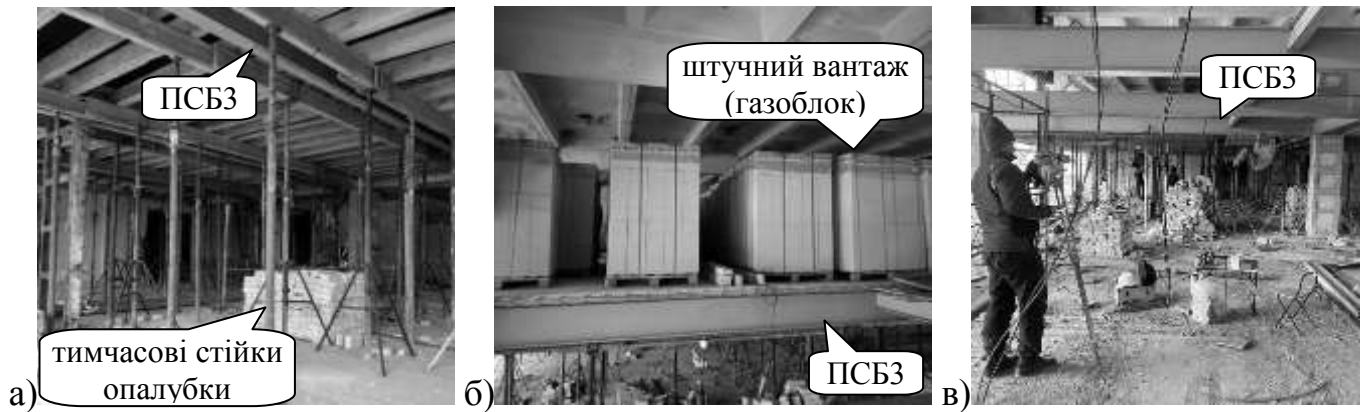
Рис. 16 – Балки ПСБЗ: а) виготовлення; б) навантаження; в) вимірювання прогинів
