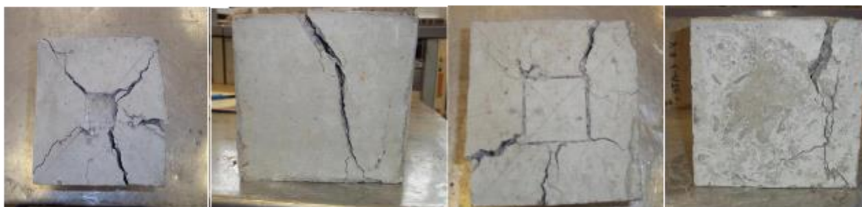
Рисунок 5.12 – Характер руйнування бетонних зразків при місцевій дії навантаження стиску [123]
