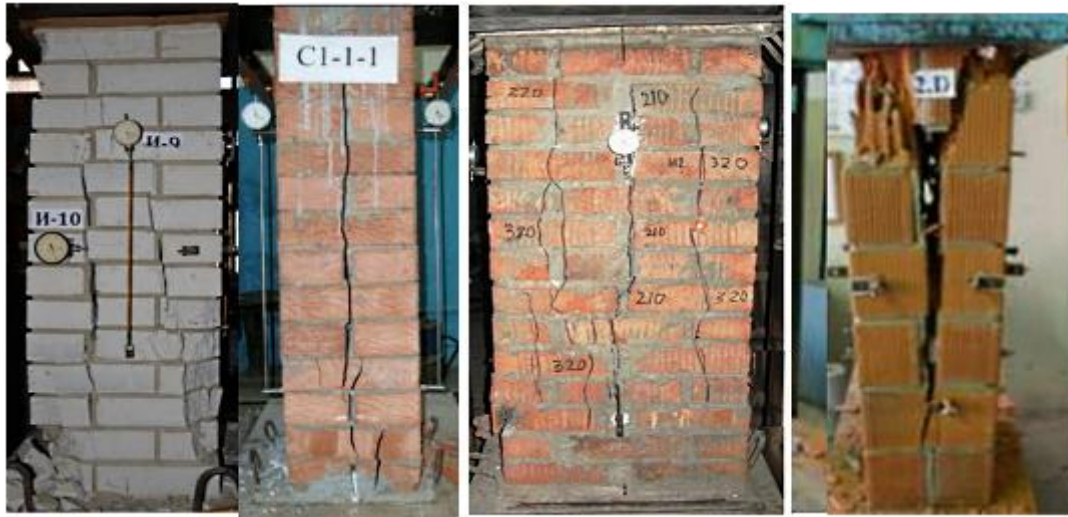
Рисунок 1.14 – Вигляд кам'яних стовпів на стадії руйнування [96 – 98]
