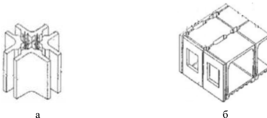
Рисунок 7.27 – Об’ємно-блокове будівництво в складних інженерно-геологічних і сейсмічних умовах:
