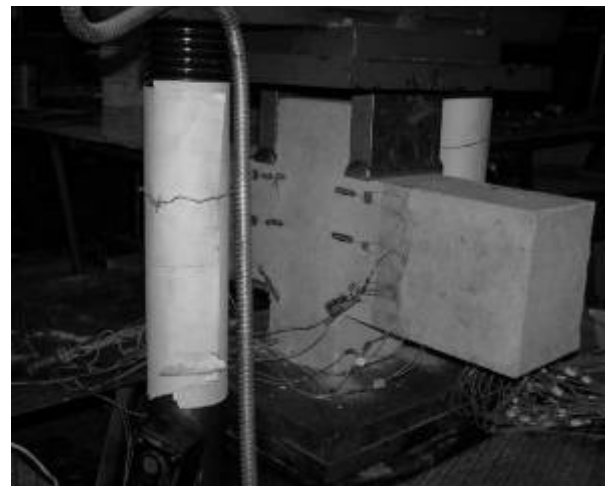
Рисунок 2.6 – Загальний вигляд, схема навантаження та розташування тензорезисторів на бетоні армованих шпонок (а), зразок ША-0,25-П-Л-0,34-1 у пресі ПГ-125 під час випробування (б)
