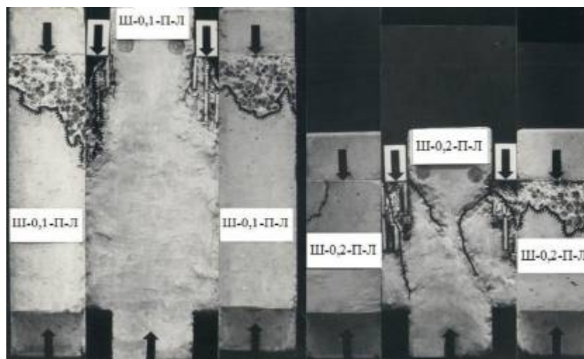
Рисунок 3.6 – Характер руйнування шпонок із керамзитобетону при l_k/h_k = 0,1 і 0,2 (при зминанні – зрізі шпонки за похилим перерізом)
