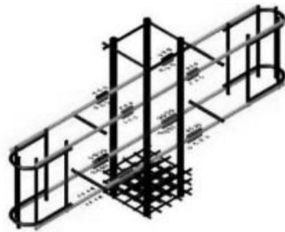
Рисунок 5 – Залізобетонні шпонки: а – розташування тензорезисторів і схема випробування; б – зразок у пресі; в – арматурні каркаси
