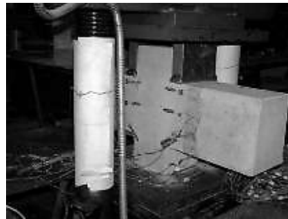
Рисунок 4 – Розташування тензорезисторів і схема випробування бетонних обтиснутих шпонок (а), зразок у пресі (б)
