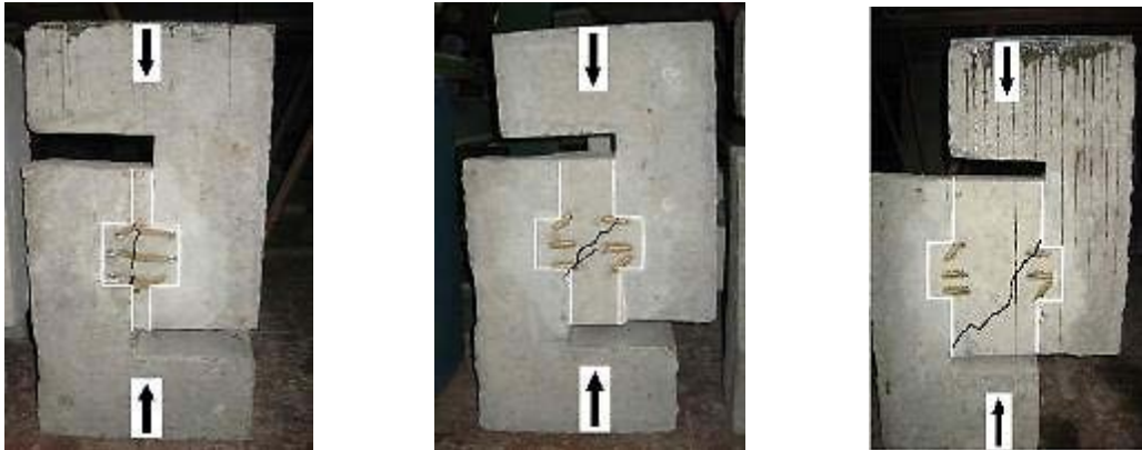
Рисунок 17 – Випадки руйнування одношпонкових з'єднань за різної ширини шва
