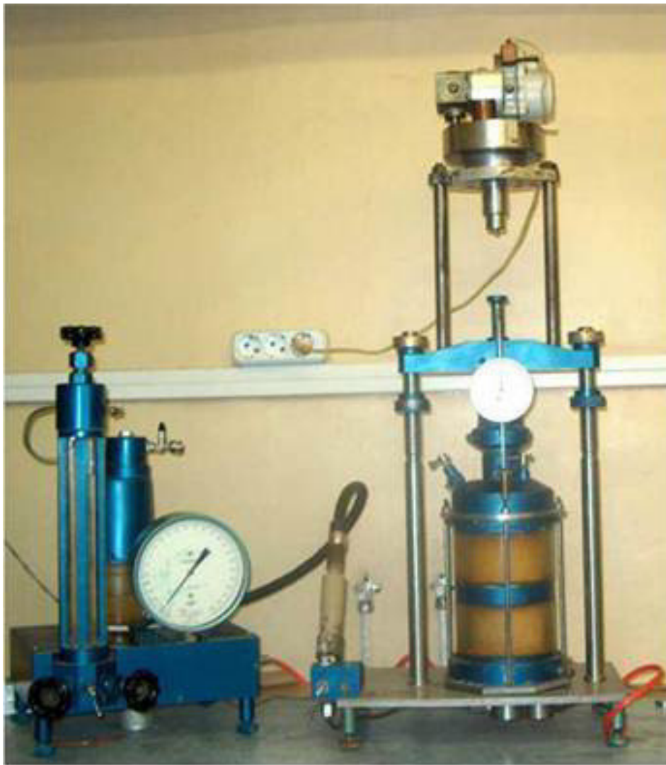
Рис. 4.14. Загальний вид приладу тривісного стиску
