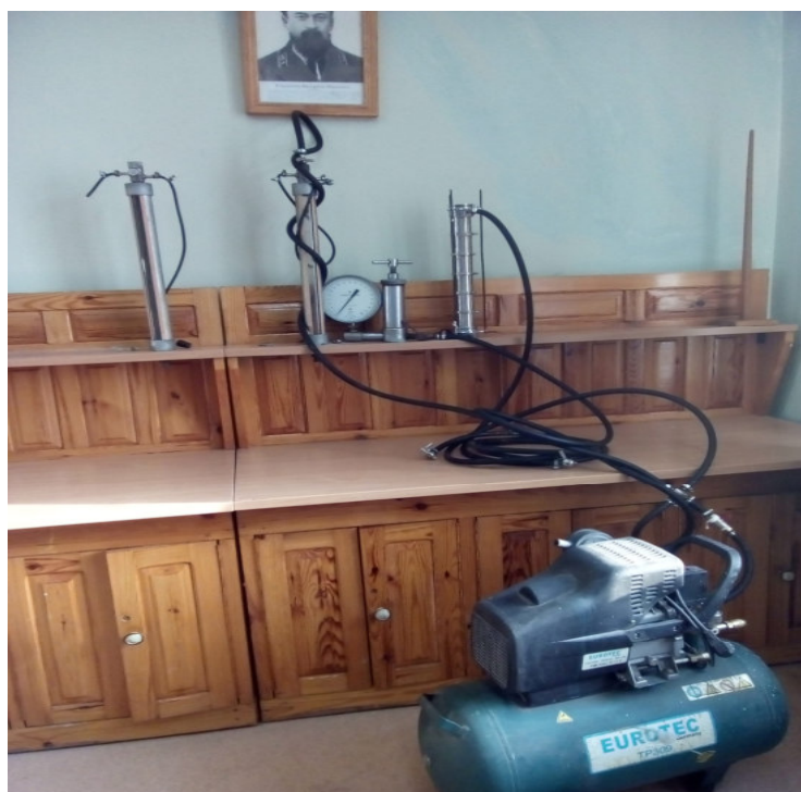
Рис. 2.3. Прилад для лабораторного хімічного закріплення ЛПЗ-2;
