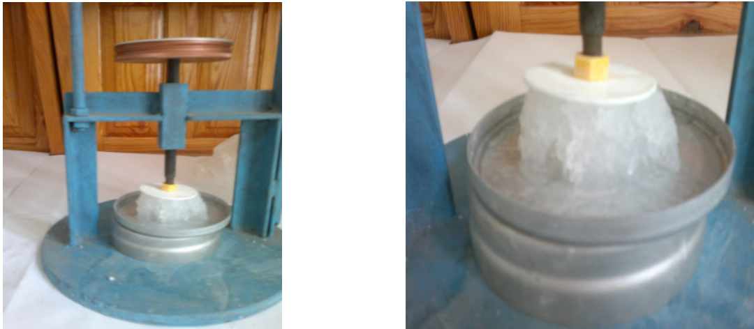
Рис. 2.6. Руйнування гелів під час випробувань на стиск
