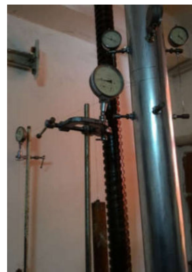
Рисунок 2.30 Розміщення прогиномірів на трубобетонних зразках ЦМБ150б
