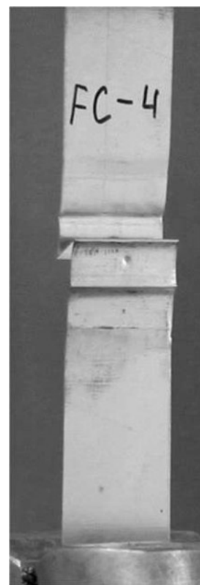
Рисунок 2.21 З'єднання фальцеве подвійне
