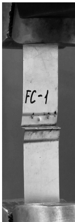
Рисунок 2.20 З'єднання фальцеве одиначне
