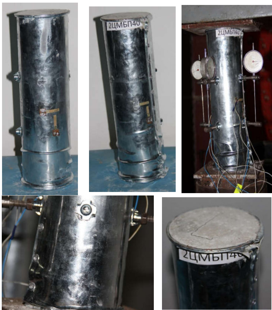
Рисунок 2.38 Характер руйнування сталезалізобетонних конструкцій з навантаженням на весь переріз ЦМБП40
