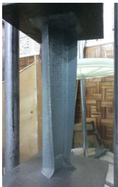
а) руйнування непідсиленого профілю П40
