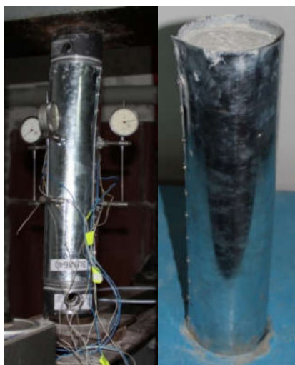
Рисунок 2.29 Характер деформування бетонного ядра у трубобетонних конструкціях ЦМБ40б
