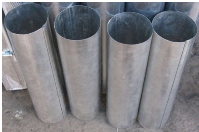
Рисунок 2.7 Трубні елементи з одиночним фальцем, які потребують підсилення фальцевого з'єднання.
