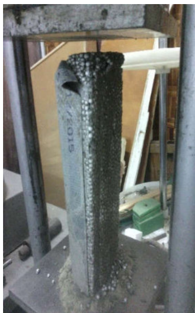
б) руйнування підсиленого полістиролбетоном профілю, \rho = 400 \text{ кг/м}^3 ПП40
