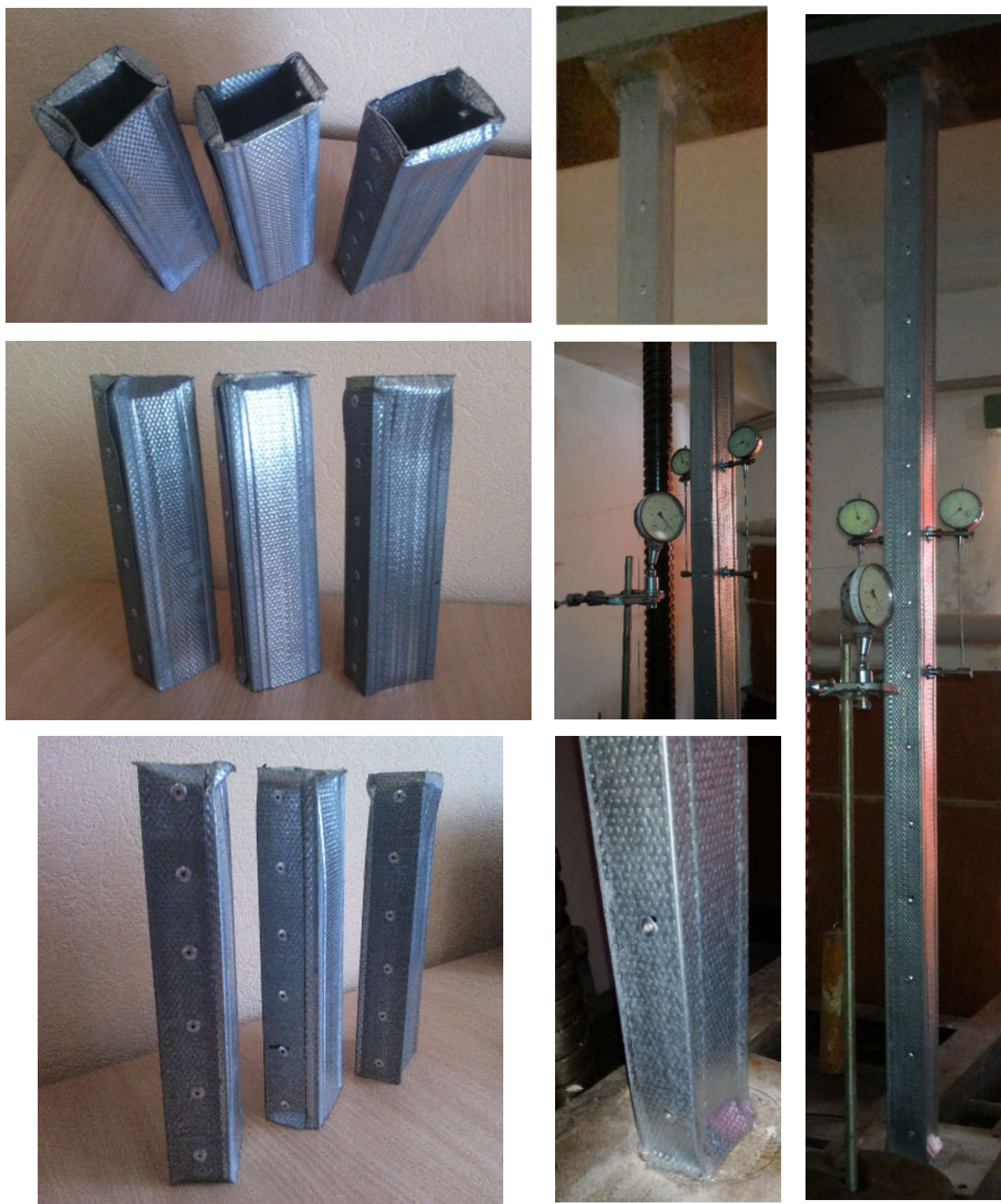
Рисунок 2.42 Характер руйнування сталевих конструкцій складеного прямокутного перерізу ПМ40 та ПМ150.
