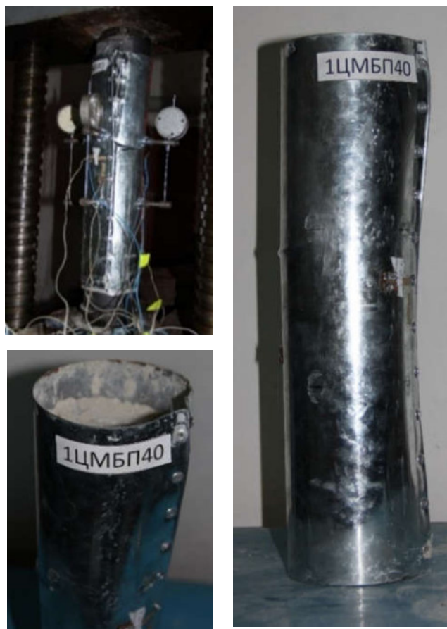
Рисунок 2.37 Характер руйнування сталезалізобетонних конструкцій з навантаженням на бетонне ядро і профіль ЦМБП40б
