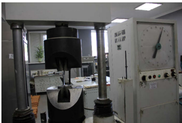
Рисунок 2.17 Випробування сталевих смуг на розривній машині МР-500.
