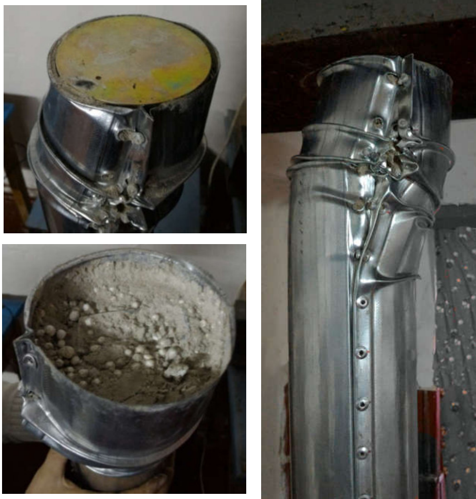
Рисунок 2.39 Характер руйнування сталезалізобетонних конструкцій з навантаженням на бетонне ядро і профіль ЦМБП1506
