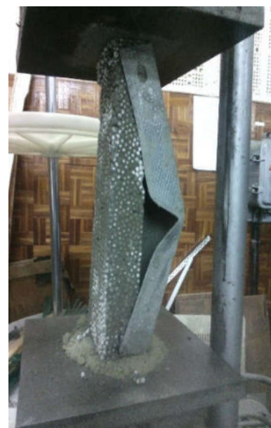
в) руйнування підсиленого полістиролбетоном профілю, \rho = 750 \text{ кг/м}^3 ПП40
