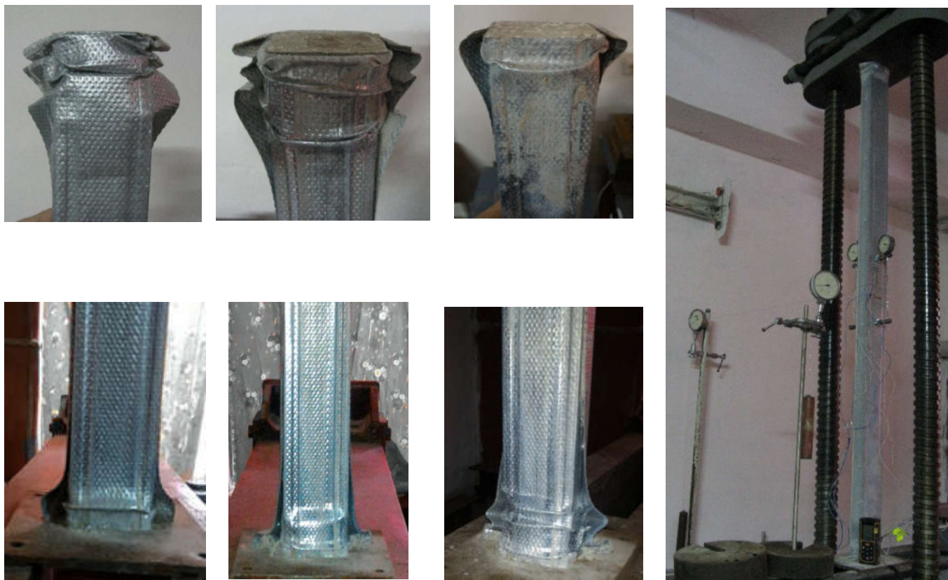
Рисунок 2.44 Характер руйнування довгих сталезалізобетонних конструкцій складеного перерізу ПМБ150
