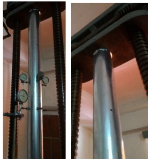
Рисунок 2.26 Характер руйнування сталеві труби ЦМ150
