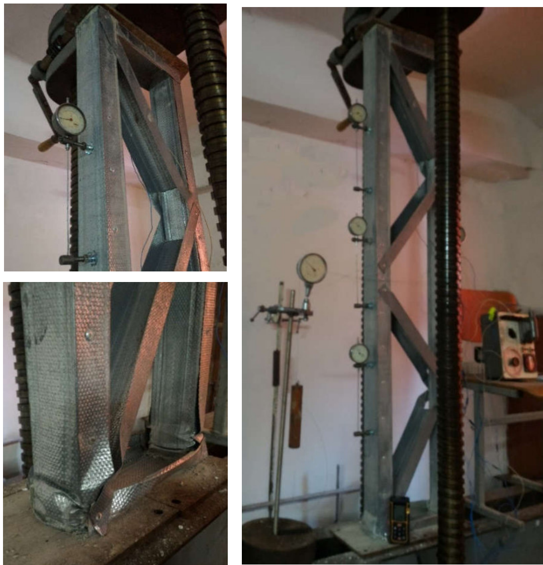
Рисунок 2.46 Характер руйнування решітчастої сталезалізобетонної стійки ПСБ150
