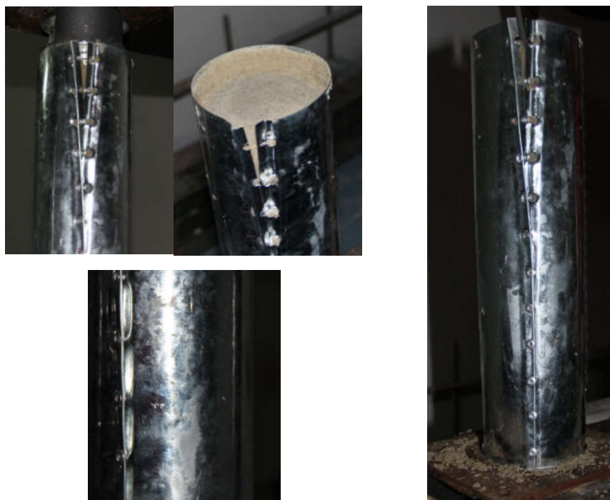
Рисунок 2.31 Характер руйнування сталевій тонкостінній труби заповненої кварцовим піском ЦМП40
