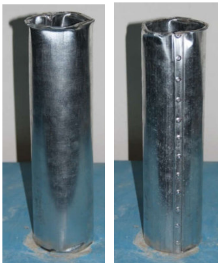
Рисунок 2.25 Характер руйнування сталеві труби ЦМ40
