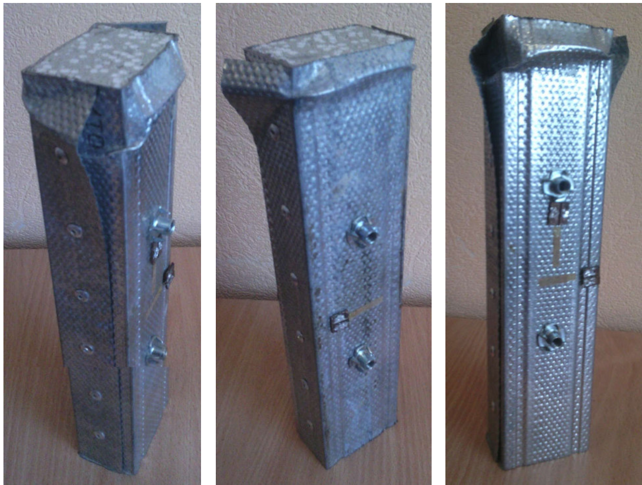
Рисунок 2.43 Характер руйнування коротких сталезалізобетонних конструкцій складеного перерізу ПМБ40
