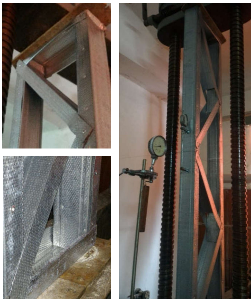
Рисунок 2.45 Характер руйнування решітчастої стійки ПС150
