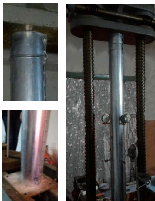
Рисунок 2.35 Характер руйнування трубобетонних конструкцій з навантаженням на весь переріз ЦМБ150
