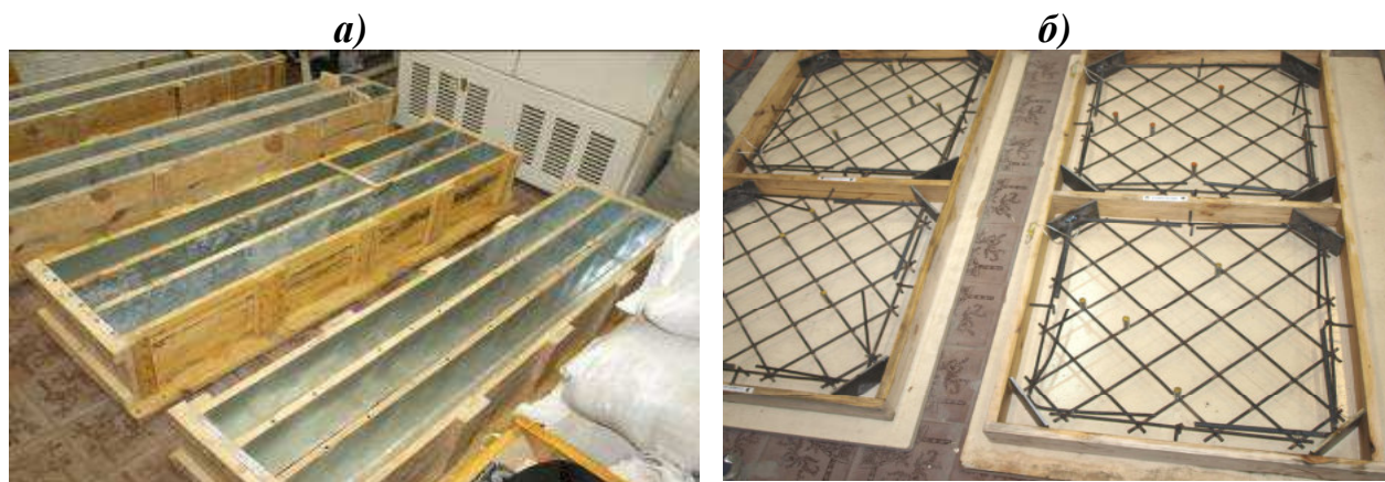
Рис. 6.4. Опалубні форми основних зразків: стрижневих (а) і плосконапружених (б) залізобетонних конструкцій
