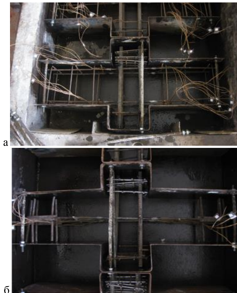
Рисунок 2.10 – Арматурний каркас в опалубці для виготовлення зразків-шпонок: а – першого, б – другого типу
