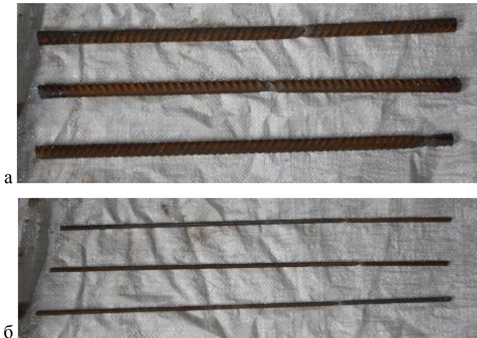
Рисунок 3.4 – Характер руйнування арматурних стержнів каркасів для балок другої серії: а – поздовжня арматура; б – поперечна арматура
