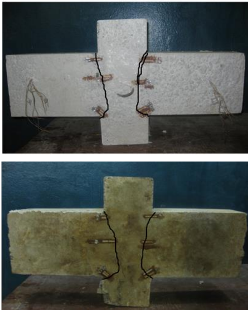
Рисунок 3.22 – Характер руйнування дослідного зразка ША-0,25-П-ПМ-0,357-1-а
