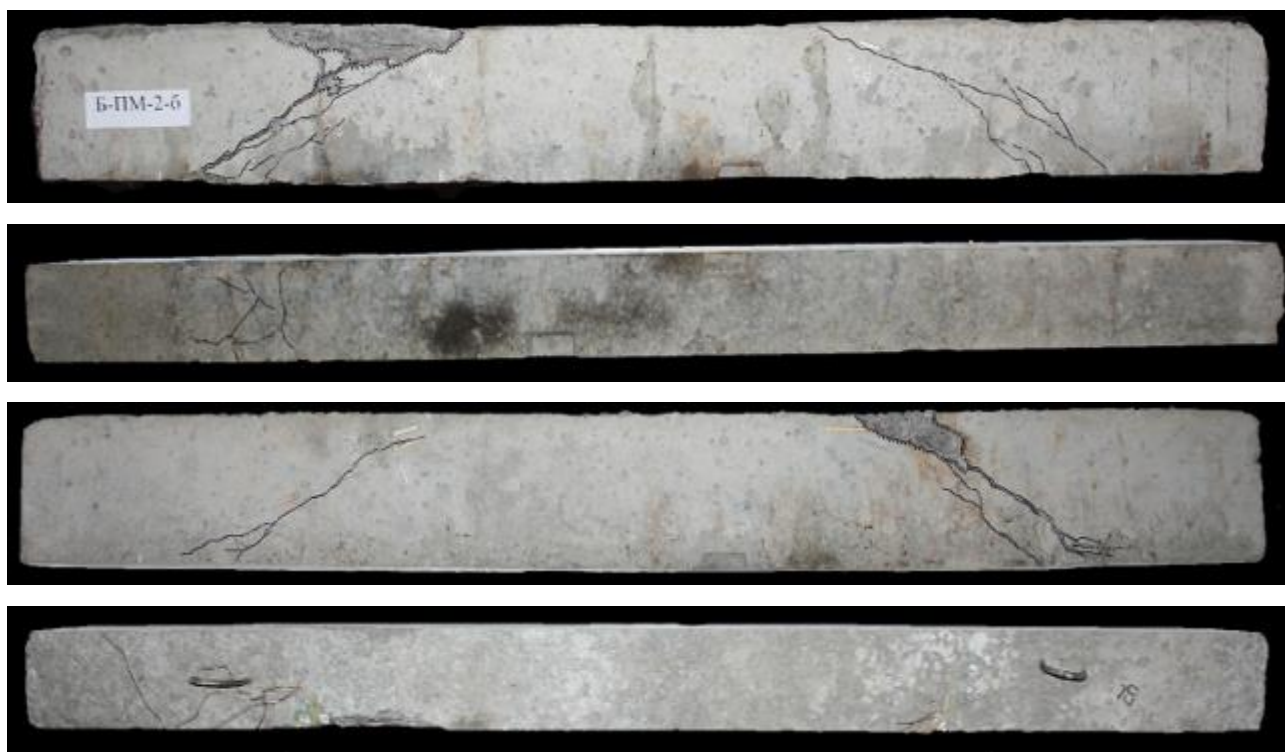
Рисунок 3.37 – Характер руйнування балки Б-ПМ-2-б
