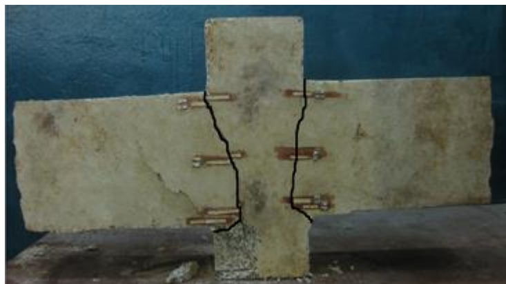
Рисунок 3.23 – Характер руйнування дослідного зразка ША-0,25-П-ПМ-0,337-1-б
