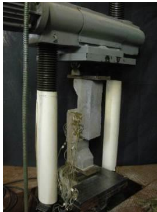
Рисунок 2.9 – Зразок Гвоздева в процесі випробування у пресі ПГ-125
