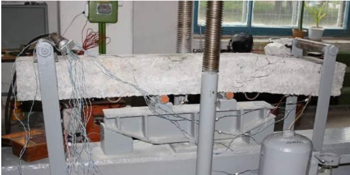
Рисунок 2.24 – Випробування балки 1Б – ФБ – 1 на згин
