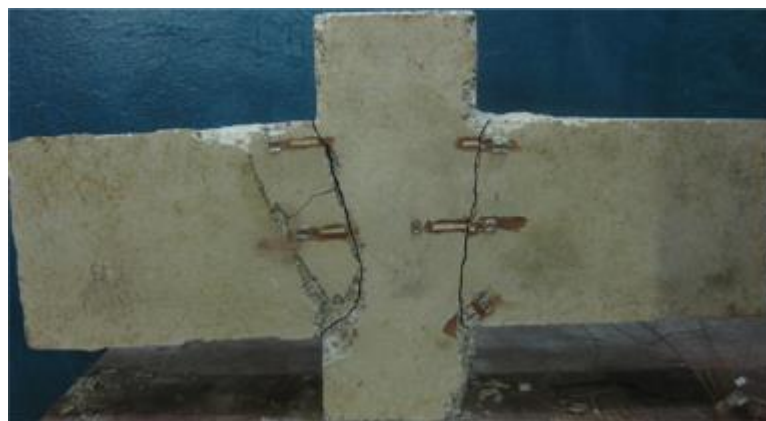
Рисунок 3.24 – Характер руйнування дослідного зразка ША-0,25-П-ПМ-0,386-2-а
