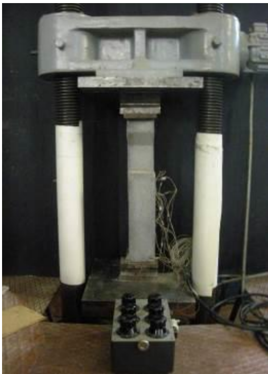
Рисунок 2.9 – Зразок Гвоздева в процесі випробування у пресі ПГ-125
