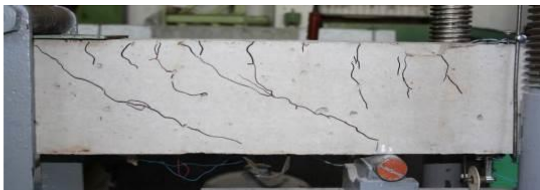
Рисунок 3.34 – Характер тріщиноутворення в процесі випробування балки БМ1
