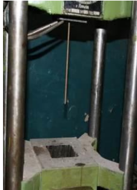
Рисунок 2.27 – Випробування стержнів для визначення механічних характеристик арматури
