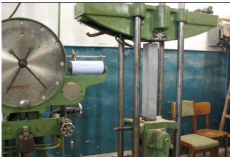
Рисунок 2.26 – Загальний вигляд установки під час випробування призми на розтяг
