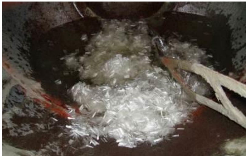
Рисунок 2.19 – Поліпропіленова фібра у бетонозмішувачі
