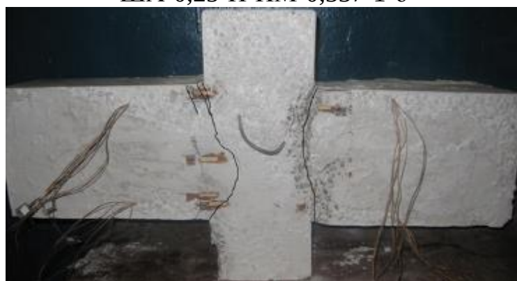
Рисунок 3.23 – Характер руйнування дослідного зразка ША-0,25-П-ПМ-0,337-1-б
