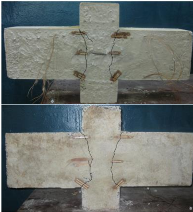
Рисунок 3.25 – Характер руйнування дослідного зразка ША-0,25-П-ПМ-0,377-2-б
