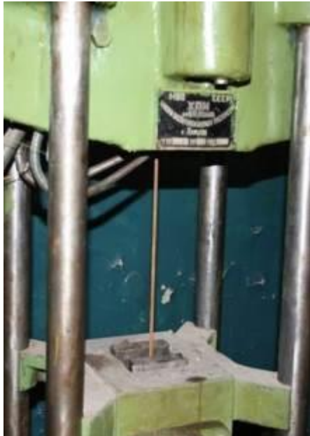
Рисунок 2.27 – Випробування стержнів для визначення механічних характеристик арматури
