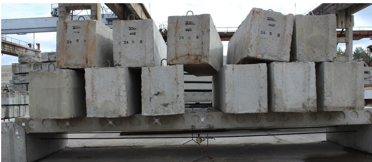
Рис. 5.16. Дослідний зразок міжколонної плити із попередньо напруженою робочою арматурою під час випробовування
