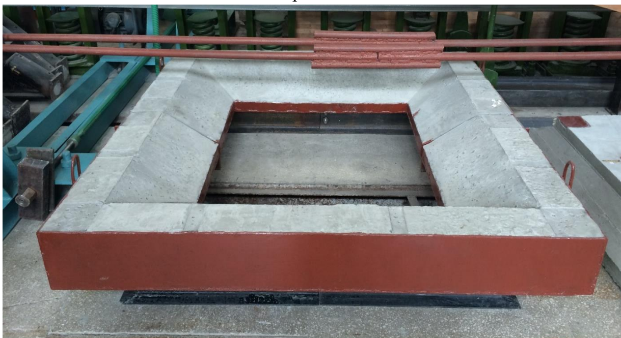
Рис. 3.7. Пристрій, що є опорою для дослідних зразків серії ПНК
