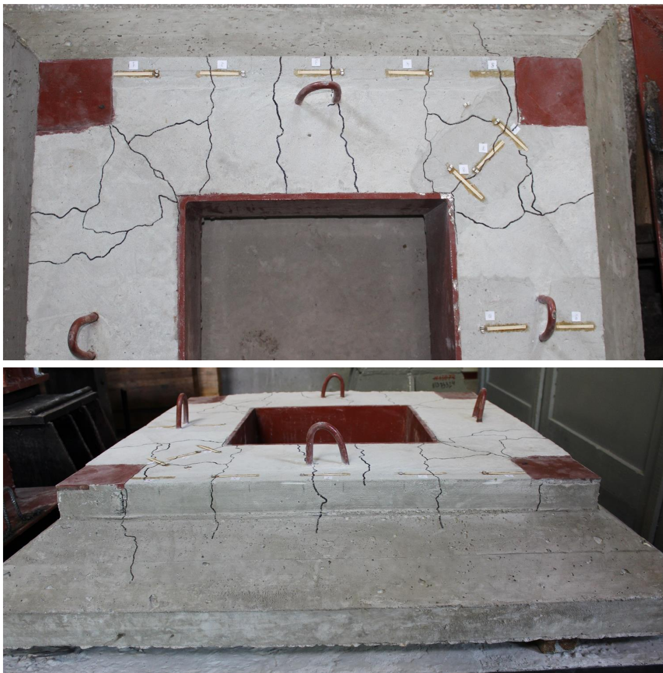
Рис. 3.22. Розподіл тріщин на верхній розтягнутій поверхні зразок серії ПНК
