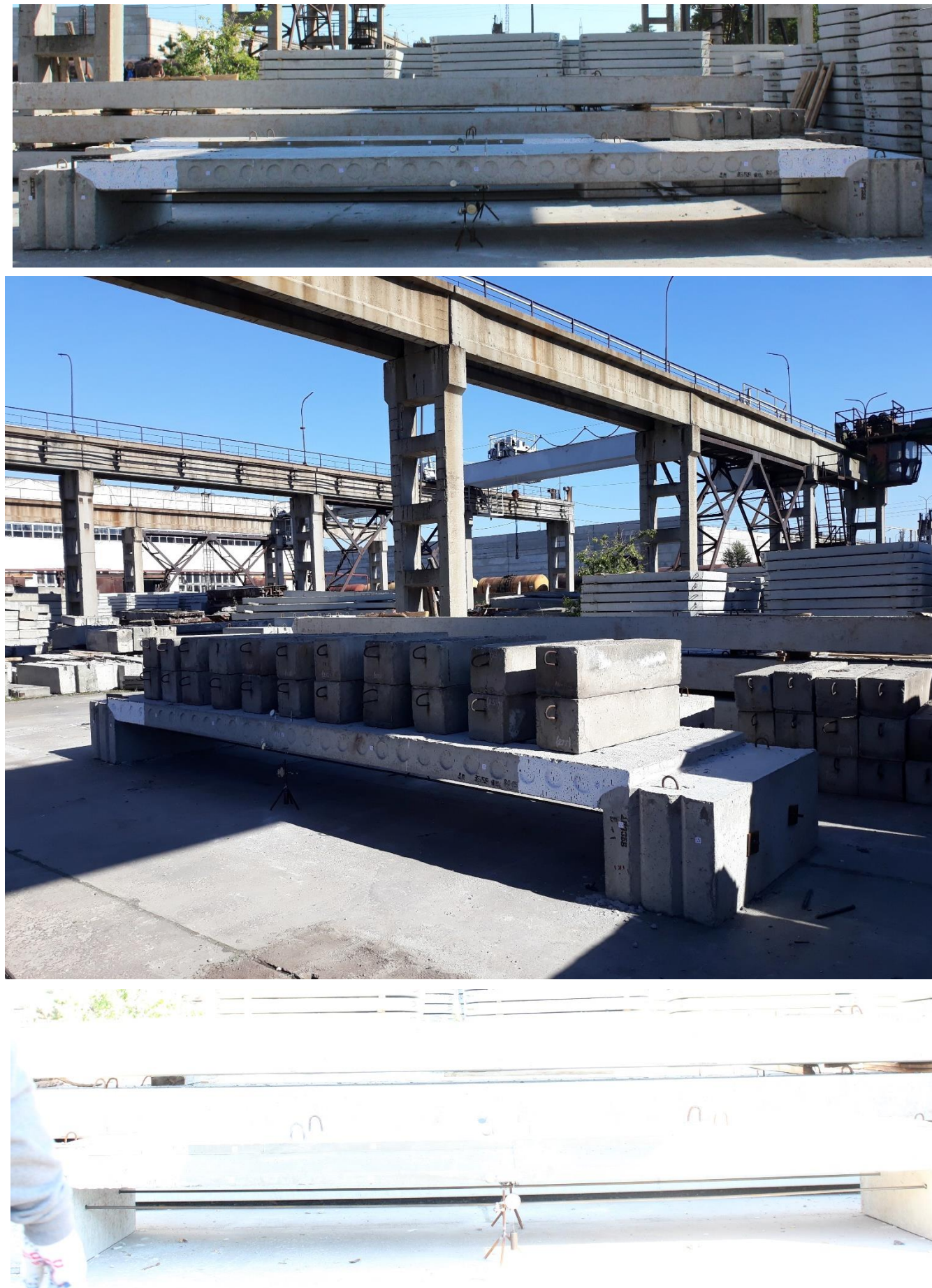
Рис. 3.15. Дослідні конструкції міжколоної та пролітної плит із нанесеними фотограмметричними маркувальними знаками
