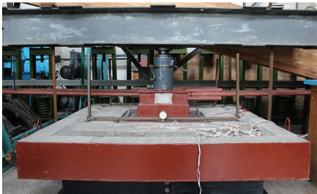
Рис. 3.11. Схема розташування індикаторів годинникового типу на дослідних зразках серії ПНК
