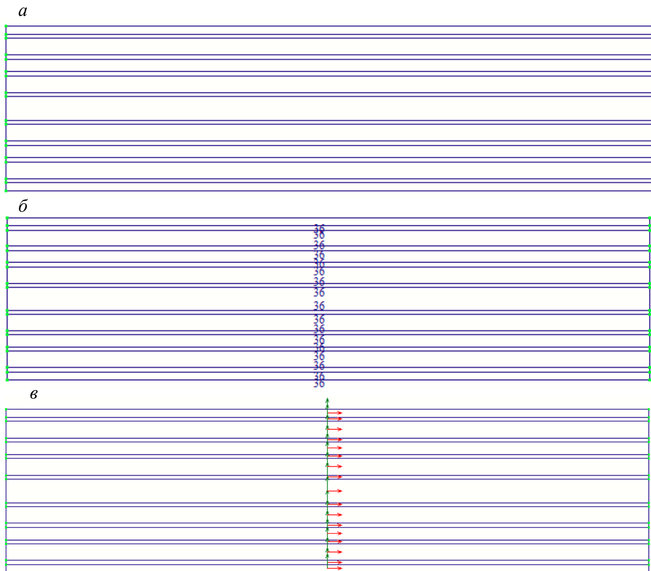
Рис. 4.18. Нижній шар кінцееlementної моделі міжколонної плити: a – загальна мозаїка; б – тип КЕ; в – напрямок внутрішніх осей
