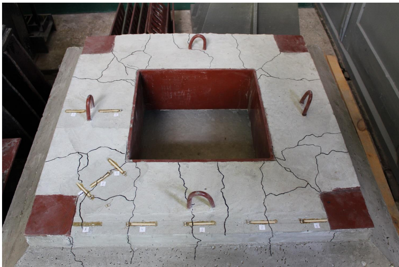
Рис. 3.28. Тріщини на поверхні бетону зразка серії ПНК
