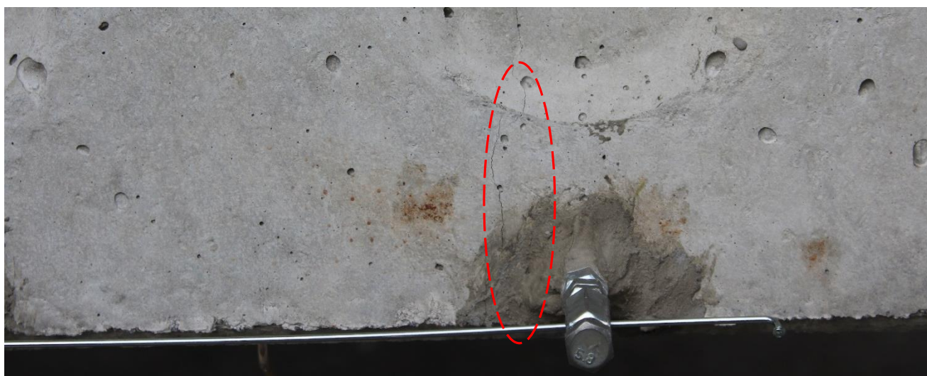
Рис. 5.19. Поява перших тріщин біля середнього поперечного перерізу при сумарному навантаженні 163 кН на зразок ПНК із попереднім напруженням
