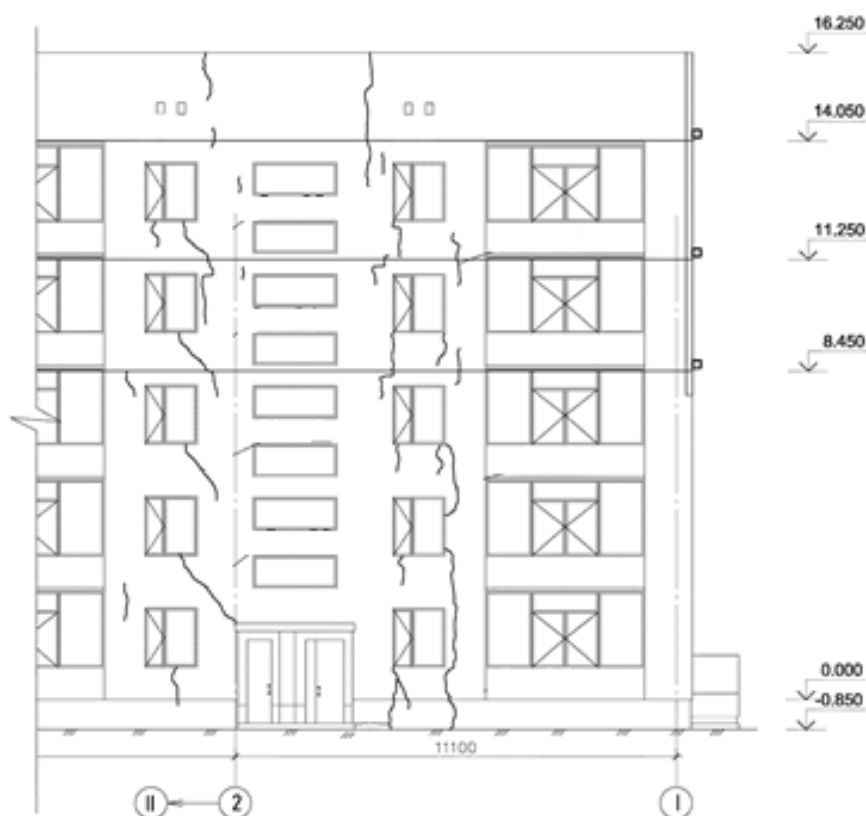
Рис. 4.18. Схема розміщення дефектів і пошкоджень у кладці зовнішніх стін на фасаді 2-I, по осі В (ліва торцева блок-секція I-II) за даними моніторингу
