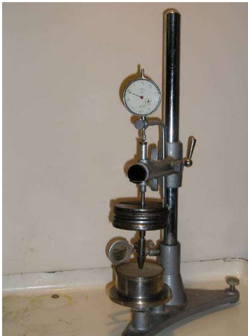
Рис. 2.10. Пенетрометр для визначення показників міцності ґрунту, прийнятий за прототип для «Пенетрометру польового» (патент на корисну модель № 41209)
