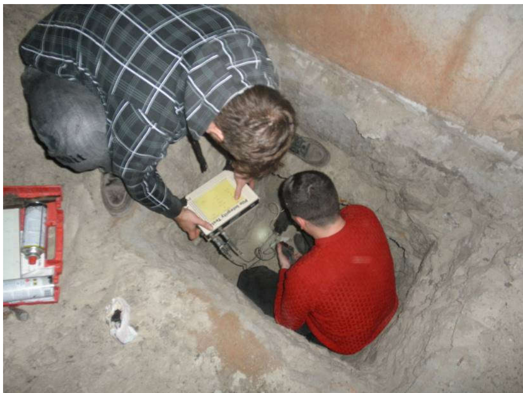
Рис. 2.17. Виконання робіт з контролю довжини паль акустичним методом
