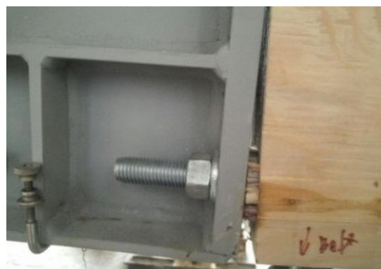
Рис. 3.14 Характер руйнування балок з металевою вставкою:
