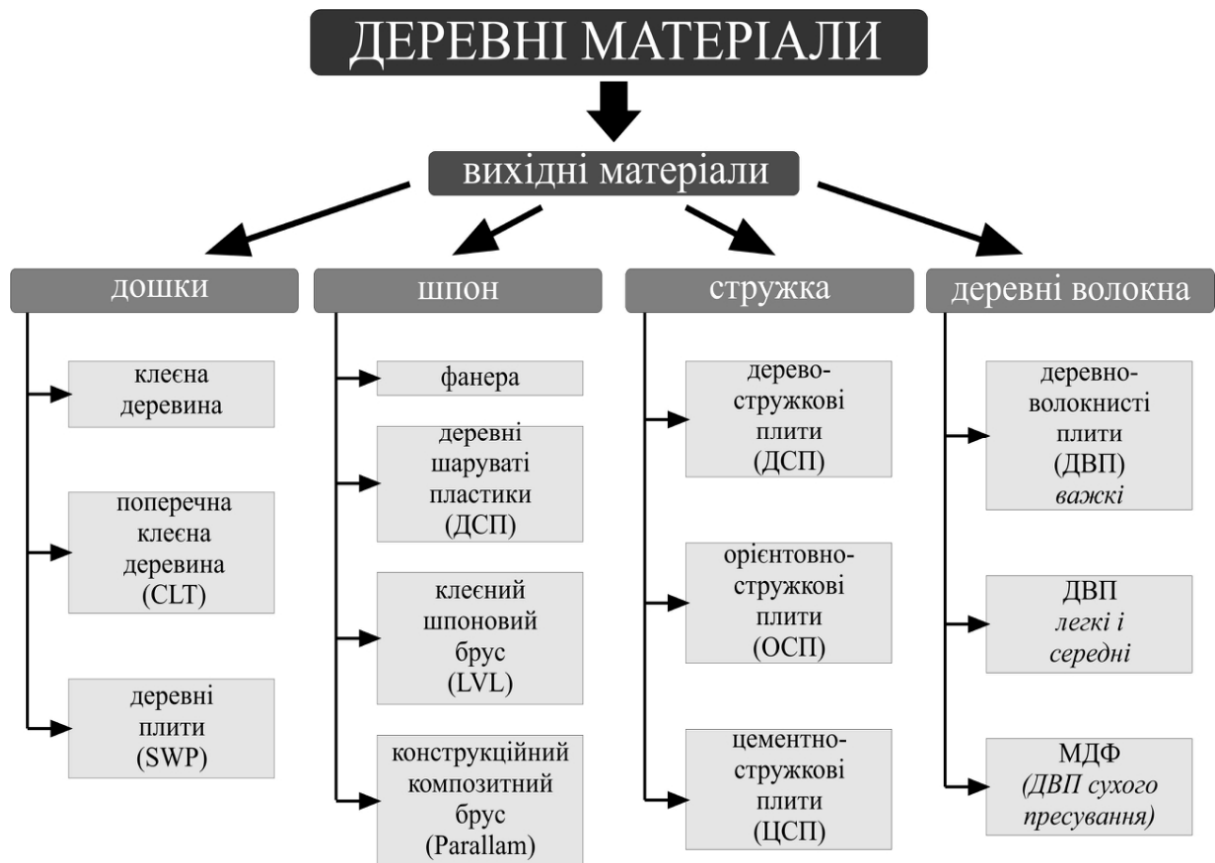
Рис. 1.1 Схема складових компонентів будівельних матеріалів на основі деревини та її відходів [7]
