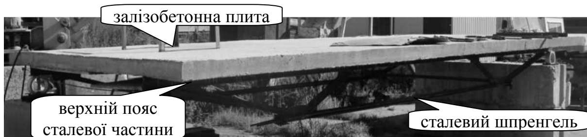
Рис. 1.22 – Однопролітна сталезалізобетонна шпренгельна конструкція [98]
