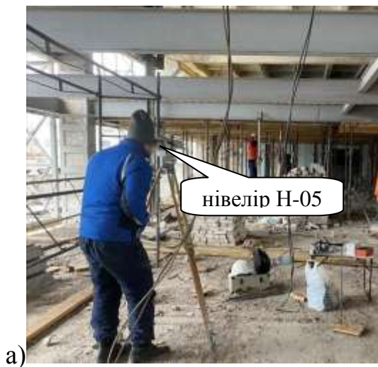
Рис. 4.31 – Проведення нівелювання вертикальних переміщень контрольних точок сталевих балок
