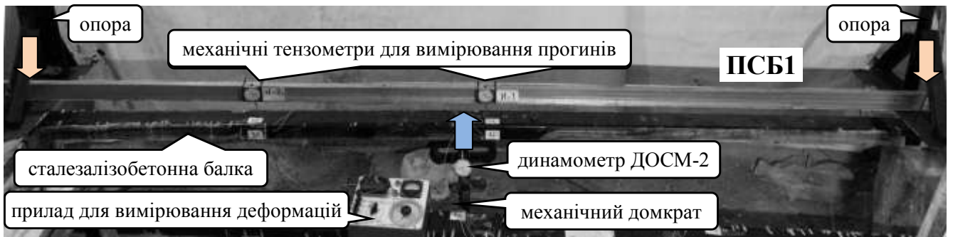
Рис. 4.23 – Загальний вигляд сталобетонних зразків під час випробувань
