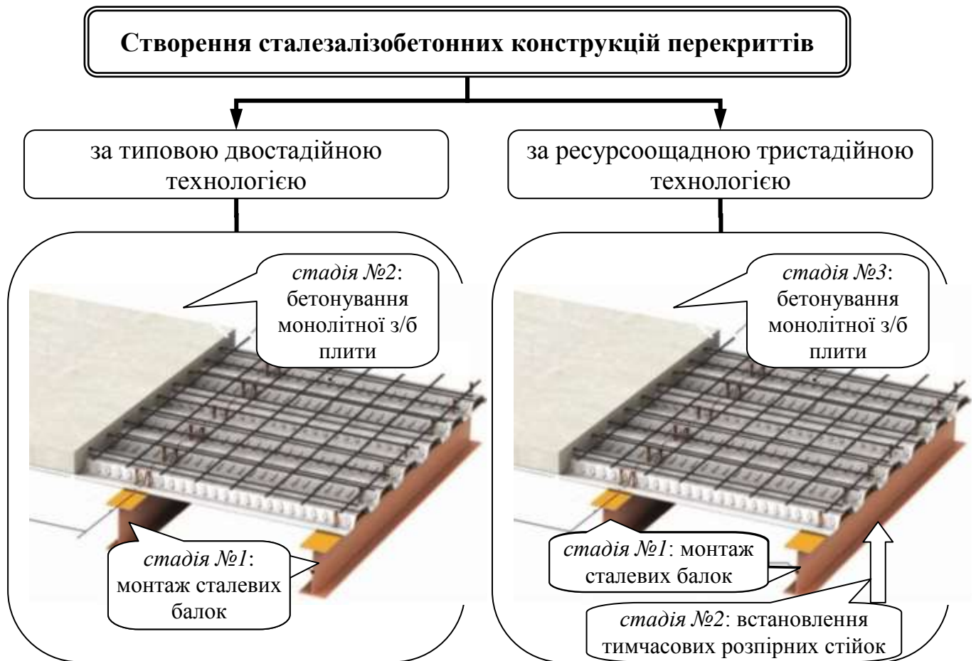
Рис. 4.1 – Багатостадійна технологія створення сталезалізобетонних перекриттів
