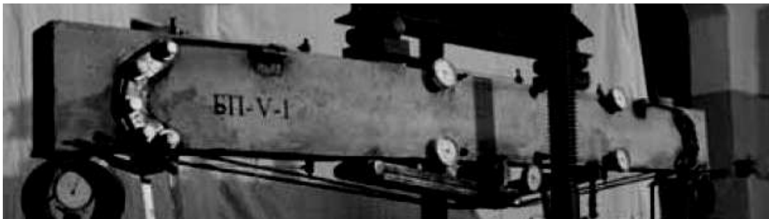
Рис. 1.4 – Вигляд з/б балки, підсиленої стрижнево-котковою системою [217]
