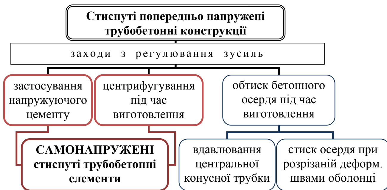
Рис. 1.25 – Заходи з регулювання зусиль у стиснутих трубобетонних конструкціях
