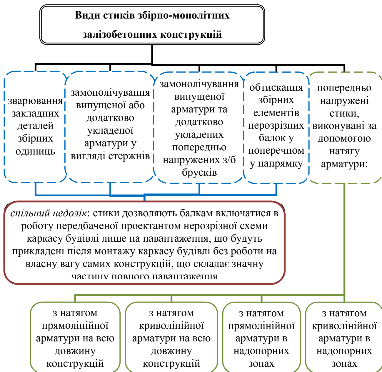
Рис. 1.34 – Класифікація стиків збірно-монолітних залізобетонних конструкцій для забезпечення їх нерозрізної статично невизначеної роботи [58]
