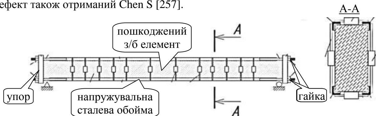
Рис. 1.39 – Схема підсилення пошкодженої залізобетонної балки сталевими обоймами [294]
