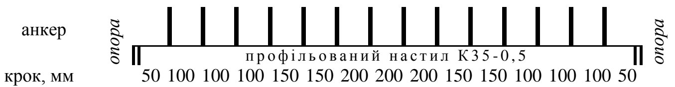
Рис. 5.28 – Крок встановлення анкерів у нижню хвилю профільованого листа
