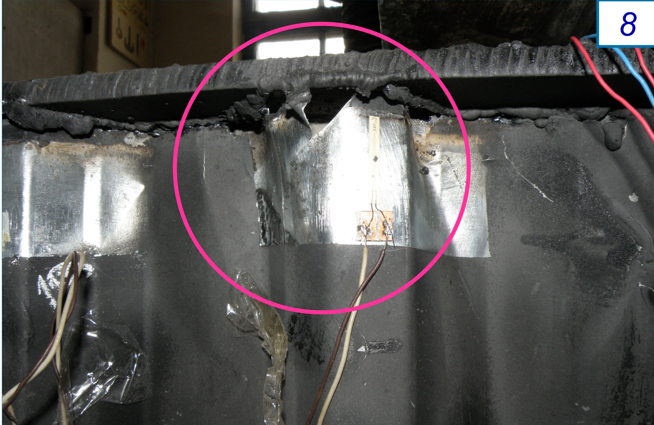
Депланація стінки експериментальної моделі балки з подвійною профільованою стінкою в результаті випробування
