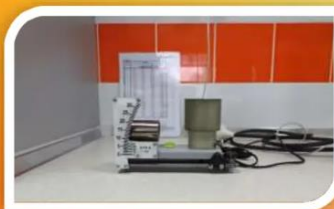
Прилад КТК-2 для визначення коефіцієнту тертя глинистої кірки
