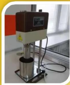
Ротаційний віскозиметр OFITE 800 для визначення динамічної в'язкості
